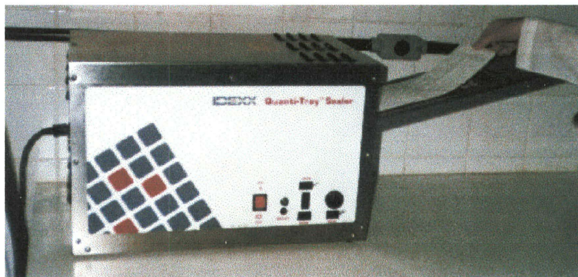
Figura 8: Cartelas estéreis sendo seladas na seladora Quanti-Tray.
