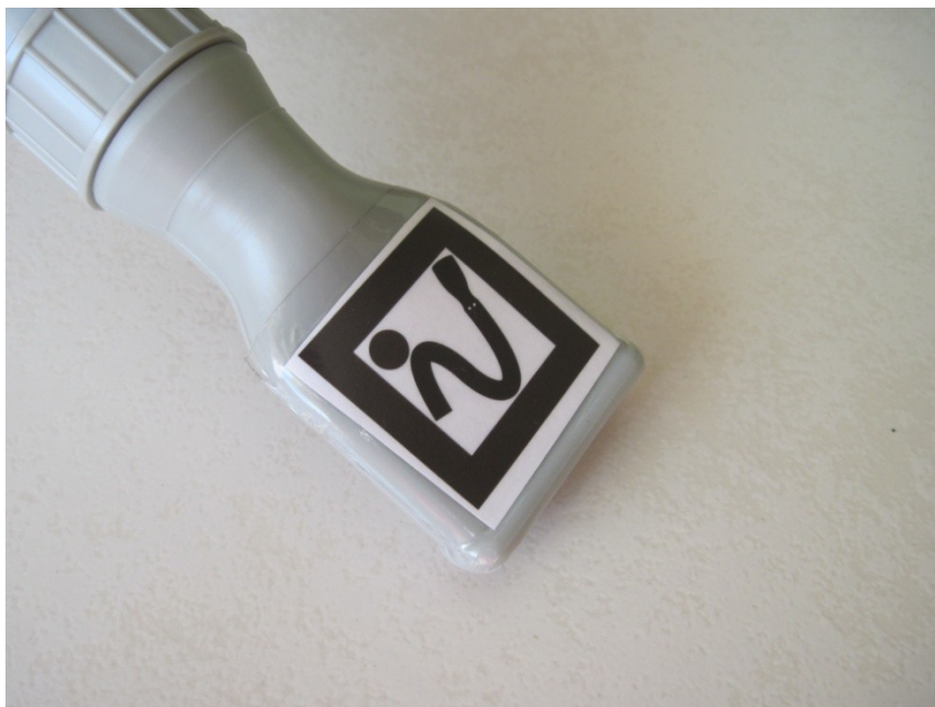
Figura 5: Exemplo de marcador fiducial (acervo pessoal)
