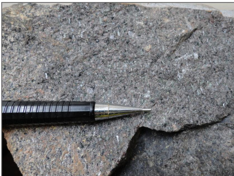
FIGURA 22 - Granito Piedade, fácies álcali-feldspato sienito com estrutura de trama magmática (amostra BC-085).
