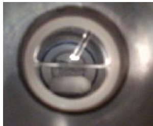
Figura 3.8 - Equilíbrio líquido-líquido (ponto F)
