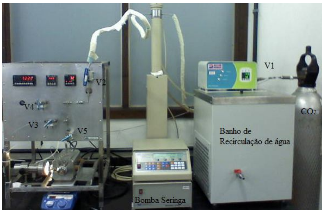
Figura 3.2 – Vista geral da unidade experimental
