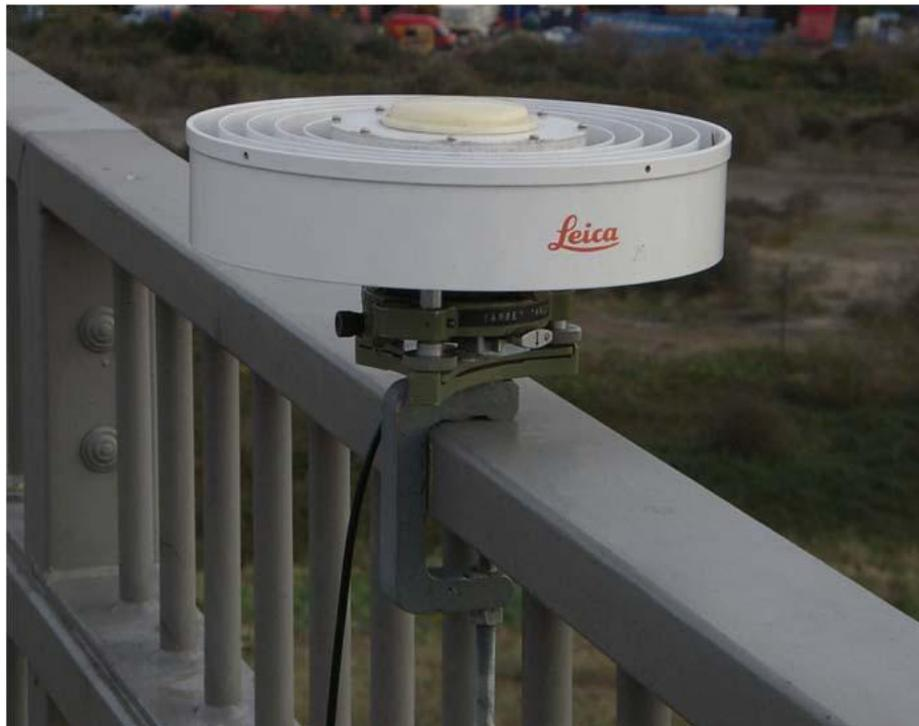
FIGURA 14 - ANTENA AT503 FIXA SOBRE O VIADUTO AVONMOUTH
