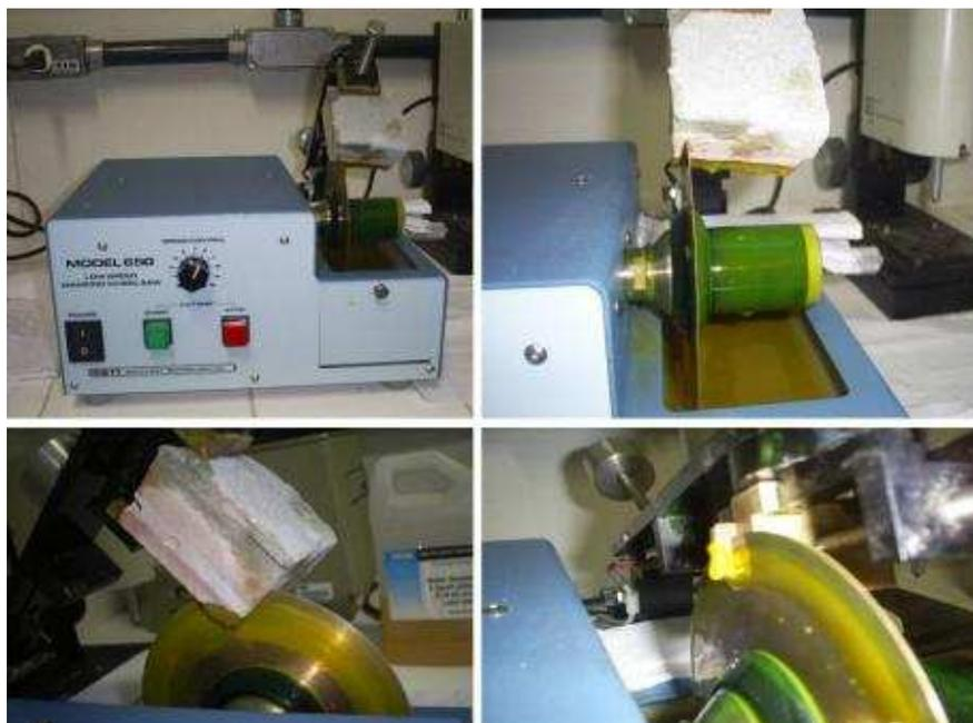
Figura 41: Obtenção de amostras para microscopia utilizando-se uma serra policorte de precisão.
