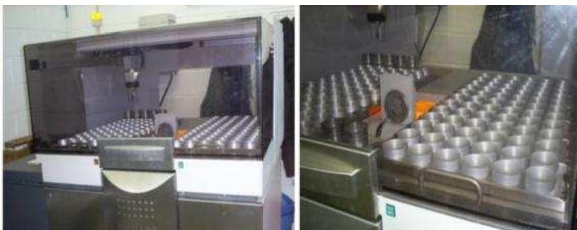
Figura 30: Equipamento Philips, modelo Magix Pro, utilizado para execução do ensaio de fluorescência de raios-X.
