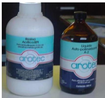
Figura 42: Resina polimérica utilizada para o embutimento.
