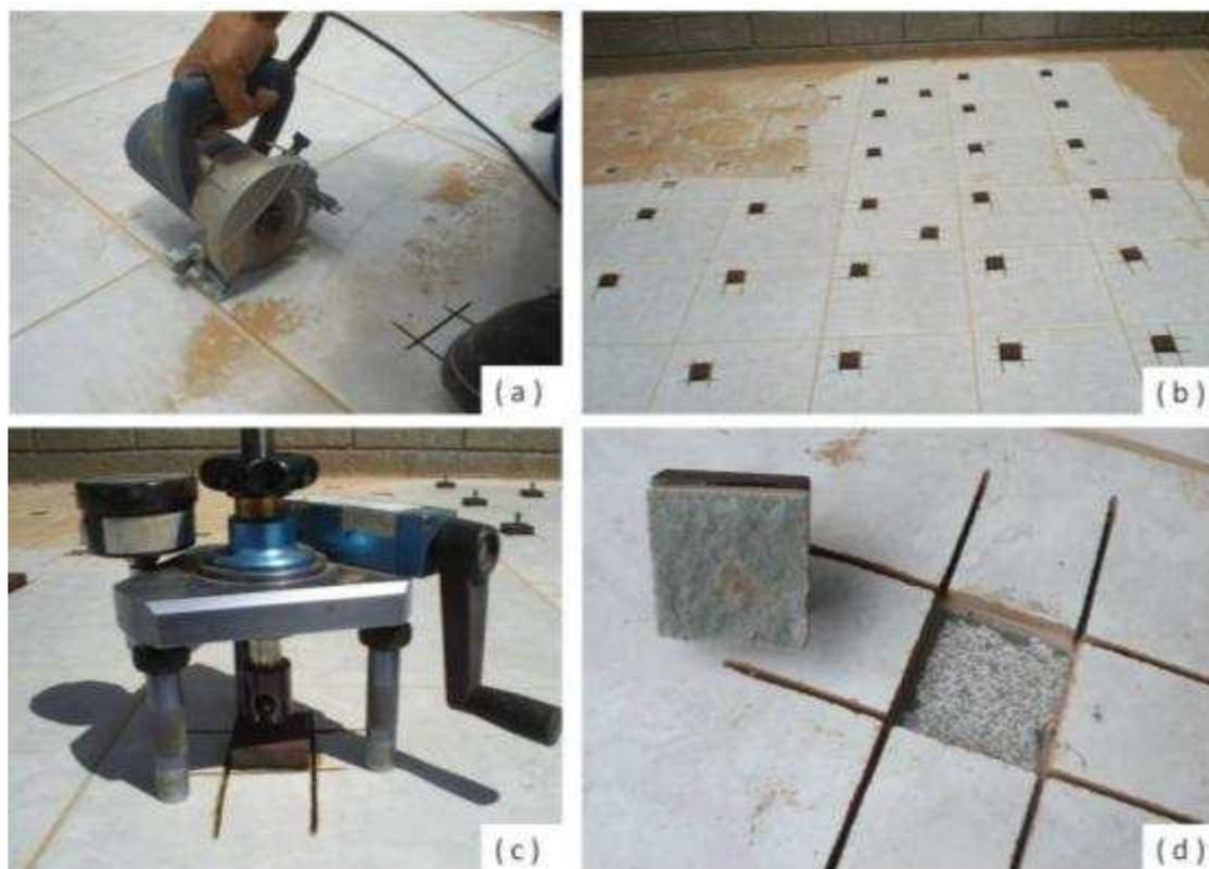
Figura 27: Ensaio de resistência de aderência: (a) Corte das placas; (b) Colagem das pastilhas; (c) Posicionamento do equipamento de arrancamento e; (d) Detalhe do piso após o ensaio.
