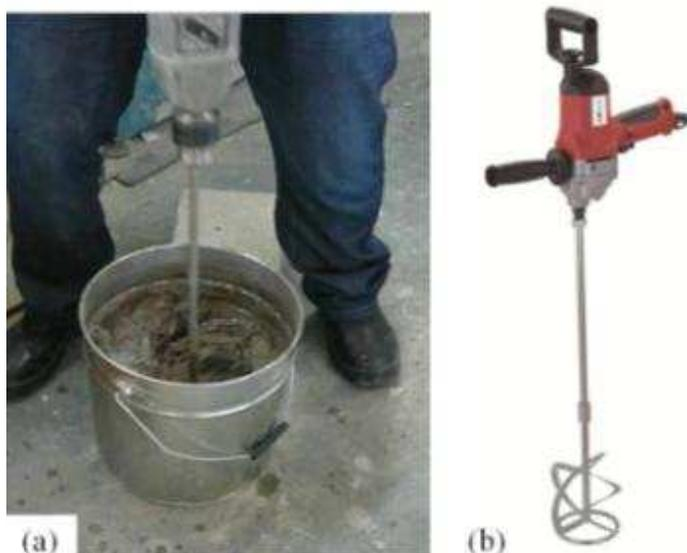
Figura 25: (a) Mistura da argamassa colante; (b) Misturador mecânico.
