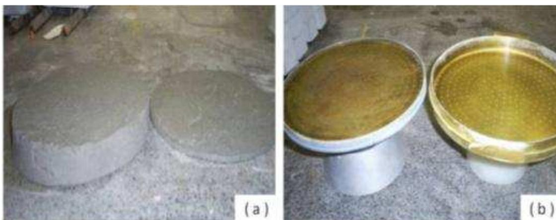
Figura 38: (A) Detalhes das espessuras das camadas de argamassa colante; (B) Pratos com argamassa colante para ensaio de retenção de água.
