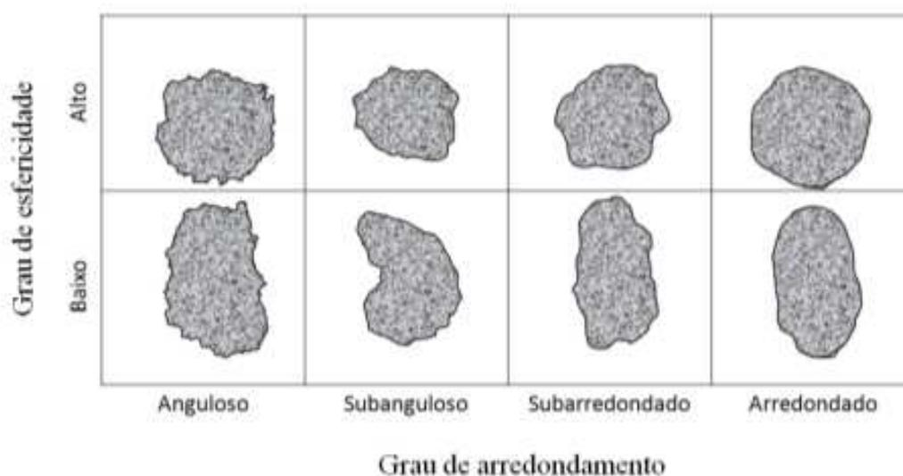
Figura 35: Avaliação visual do grau de esfericidade e de arredondamento de materiais naturais para utilização como agregado (NBR 7389-1 (2009) baseada em Power (1953)).
