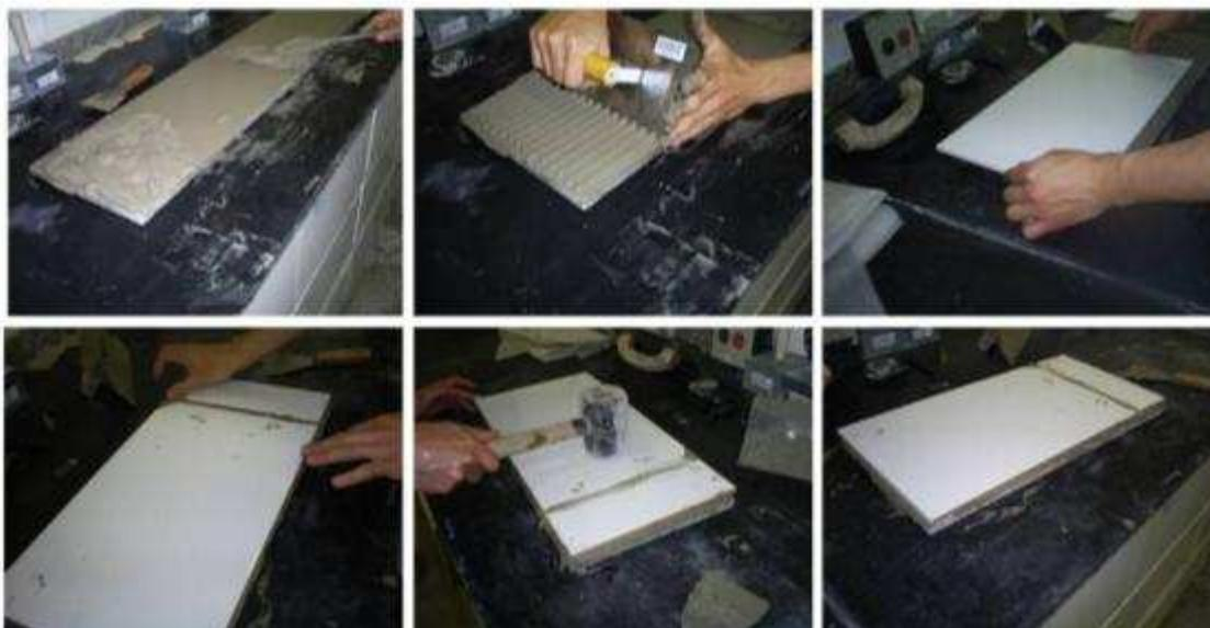
Figura 19: Moldagem dos pisos de referência.
