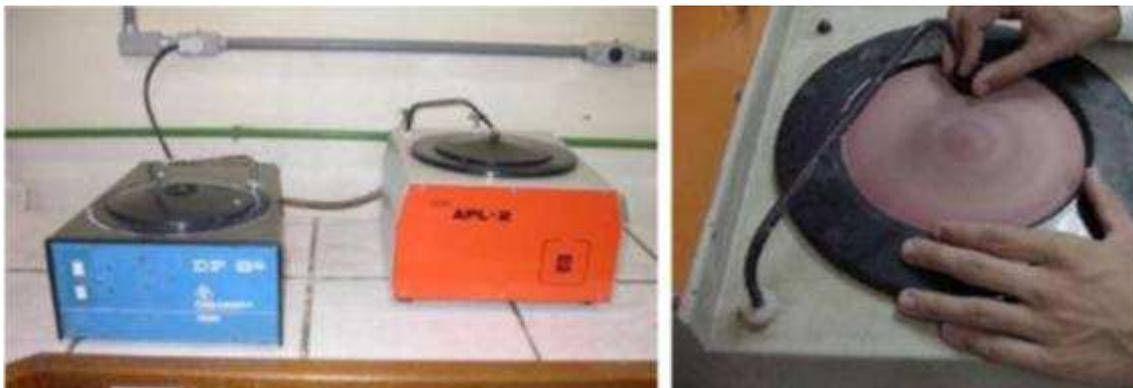
Figura 44: Preparação das amostras para microscopia: lixamento e polimento.
