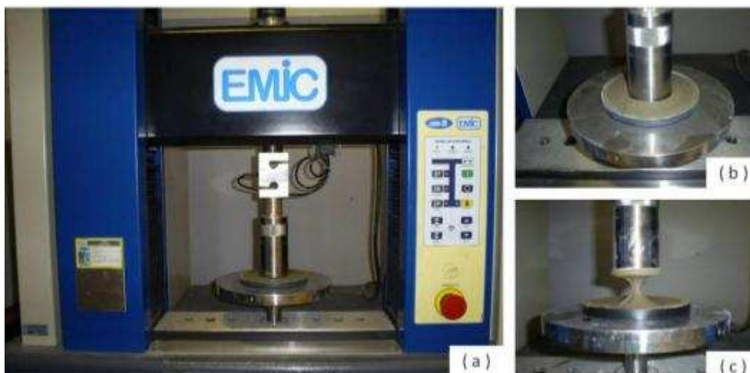
Figura 39: Ensaio de Squeeze Flow em argamassa colante: (a) execução do ensaio; (b) patamar de compressão e (c) patamar de tração durante o ensaio.
