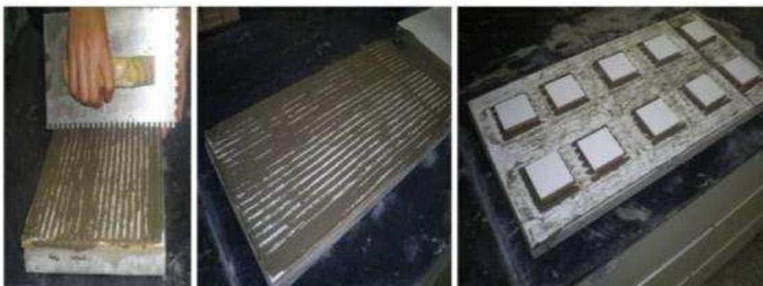
Figura 20: Moldagem das pastilhas cerâmicas para ensaio de resistência de aderência.
