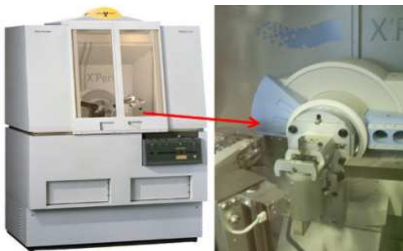
Figura 32: Difratômetro de raios-X, marca Philips, modelo X' Pert.
