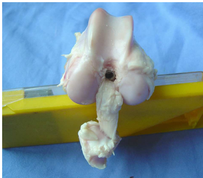
FIGURA 4 - FOTOGRAFIA DE ESPÉCIME FIXADO COM PARAFUSO DE INTERFERÊNCIA.
