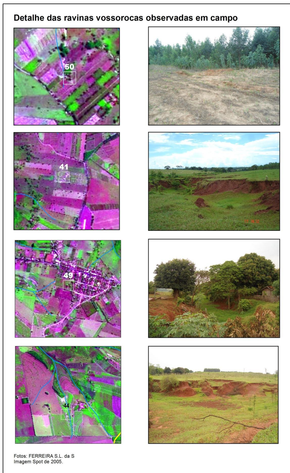
Figura 35 – Imagens de ravinas e vossorocas na área de estudo. Ponto 50- no plano inferior: nascente extinta e no superior reflorestamento em área de vossoroca. Ponto 41 e 44- ravinas e vossorocas em área de pastagem. Ponto 49- parte de vossoroca em vilarejo com extensão aproximada de três quilômetros. Fonte: imagem Spot, 2005.
