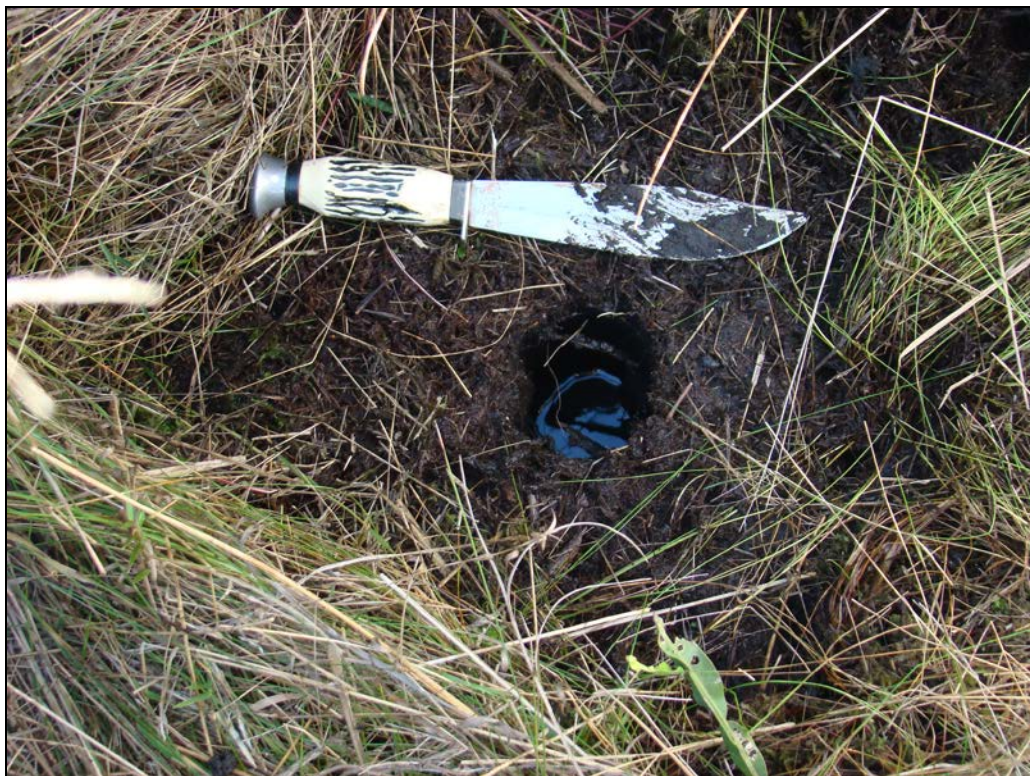
Figura 23 - Indicativo da presença do lençol freático próximo a superfície (<10 cm), caracterizando o solo como hidromórfico.
