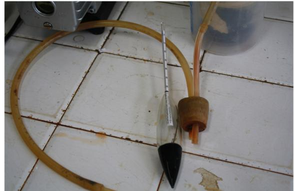
d) Densímetro utilizado para obter a densidade de argila
