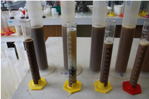
c) Solução transferida para a bureta de 250 ml e medição da densidade de argila
