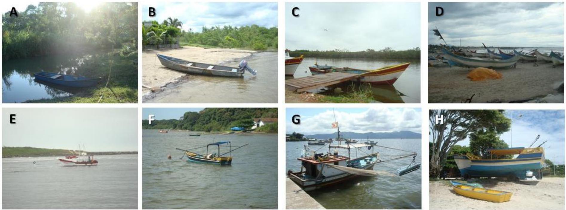
FIGURA 12 - ALGUMAS EMBARCAÇÕES DA BAÍA DA BABITONGA-SC. A = BATEIRA NOS BARRANCOS, GARUVA; B = LANCHAS NA VIGORELLI, JOINVILLE; C = BOTE SEM CABINE EM BALN. BARRA DO SUL; D = BOTES/BALEEIRAS EM ITAPEMA DO NORTE, ITAPOÁ; E = BOTE COM CABINE NA PROA EM BALN. BARRA DO SUL; F = PEQUENO BOTE SEM CABINE EQUIPADO COM TANGONES PARA O ARRASTO NOS PAULAS, SÃO FRANCISCO DO SUL; G = BOTE COM CABINE NA POPA PARA O ARRASTO NOS PAULAS, SÃO FRANCISCO DO SUL; E H = BARCO NA ENSEADA, SÃO FRANCISCO DO SUL. FONTE: O autor (2012)
