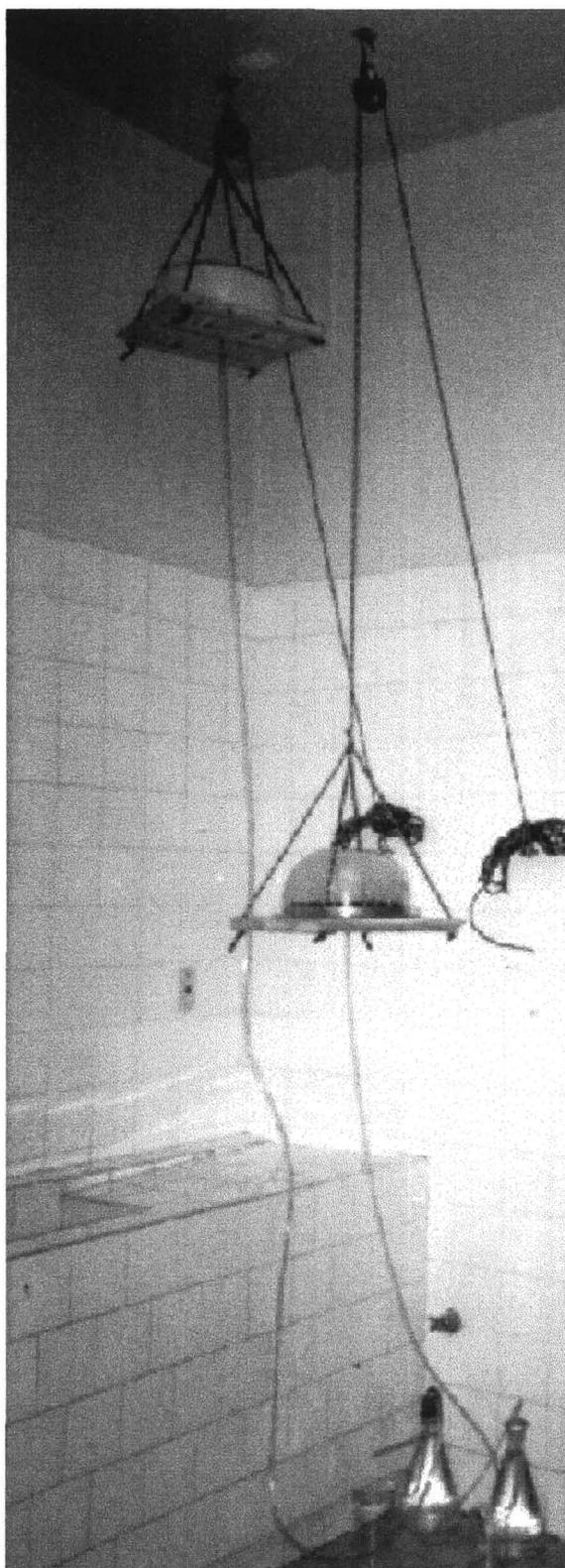
FIGURA 1 - Esquema utilizado para medir a retenção de água do solo para tensões de até 3,00 mH<sub>2</sub>O.
