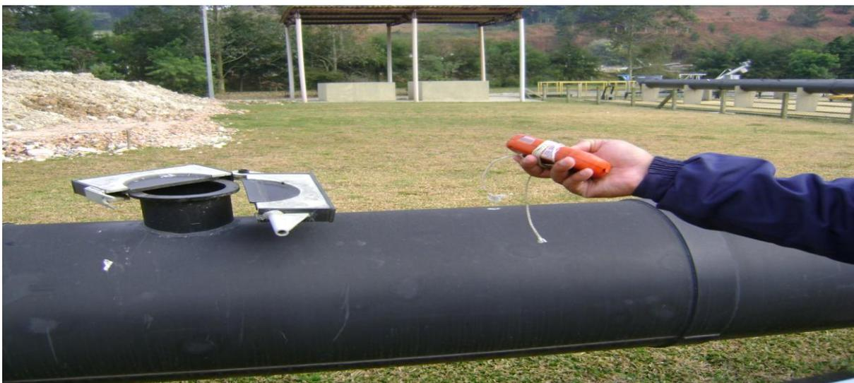
FIGURA 49 - MEDIDA DA CONCENTRAÇÃO DO H<sub>2</sub>S NA ENTRADA DO LAVADOR
