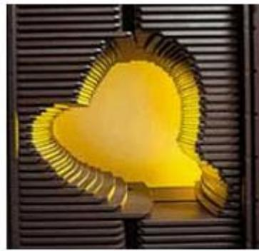
Figura 3.3: Colimador multilâminas
