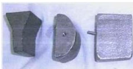
Figura 2.6: Bloco padronizado para colimação de feixe
