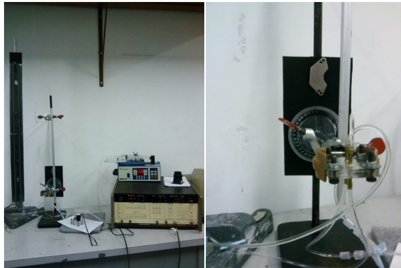
Figura 3.17 - A esquerda a montagem experimental destinada ao teste de pressão máxima e a direita o sistema de válvulas fixado em um suporte.
