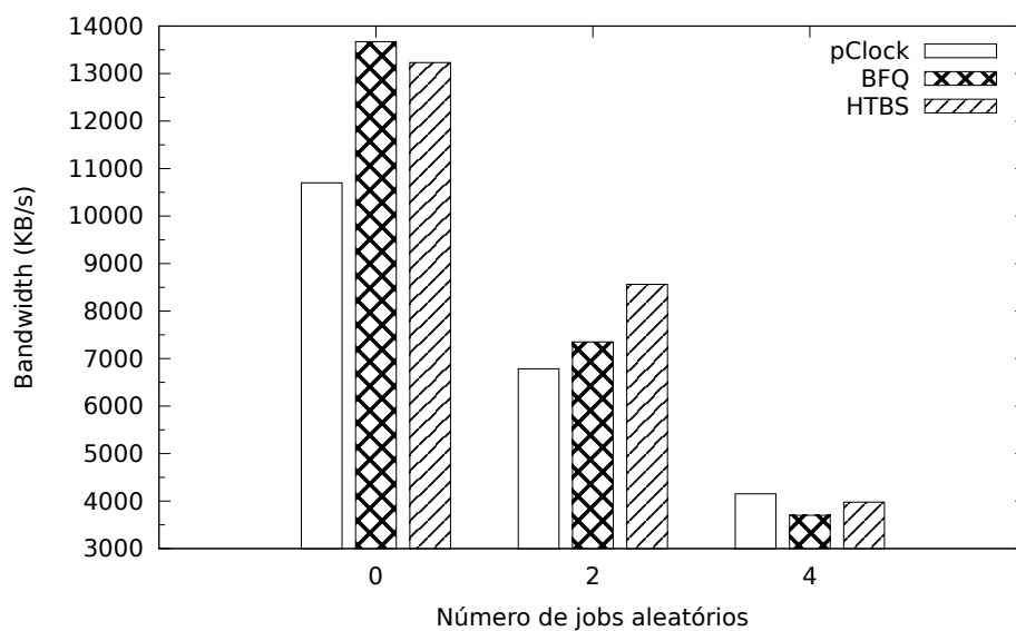
Figura 6.8: Largura de banda acumulada para os algoritmos pClock, BFQ e HTBS.
