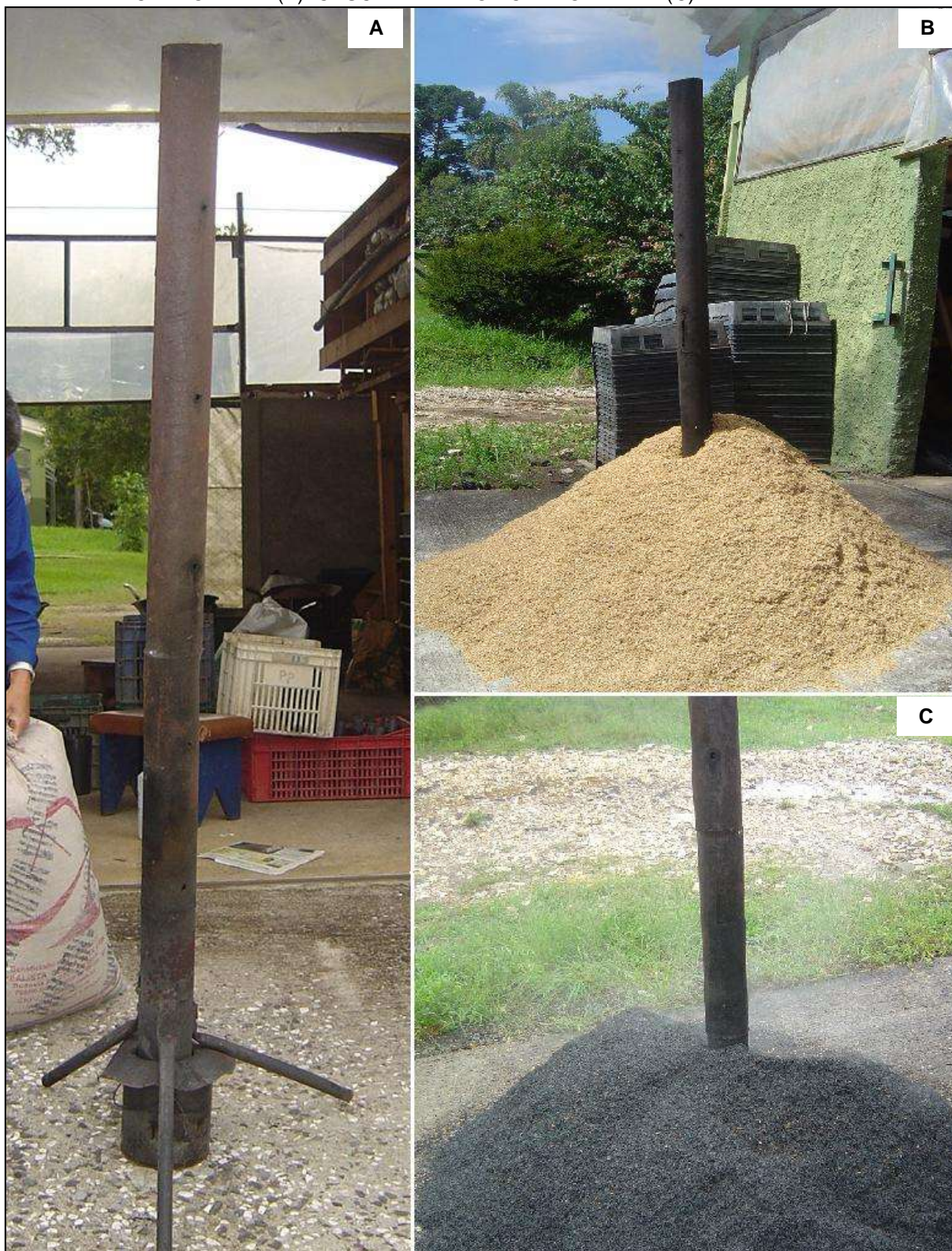
ANEXO 8 - CARBONIZAÇÃO DA CASCA DE ARROZ. CARBONIZADOR (A). CASCA DE ARROZ A CARBONIZAR (B). CASCA DE ARROZ CARBONIZADA (C).
