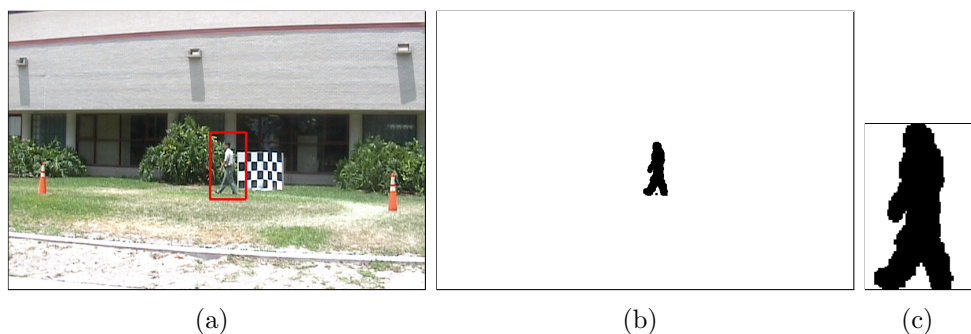
Figura 3.2: Subtração de Fundo: (a) quadro de uma sequência da forma com o retângulo delimitador em vermelho, (b) imagem binária gerada no processo de subtração deste quadro e (c) silhueta extraída.
