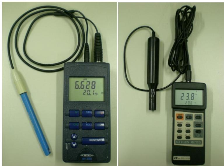
**Fotografia 1-** pHmetro e oxímetro utilizados no experimento.
