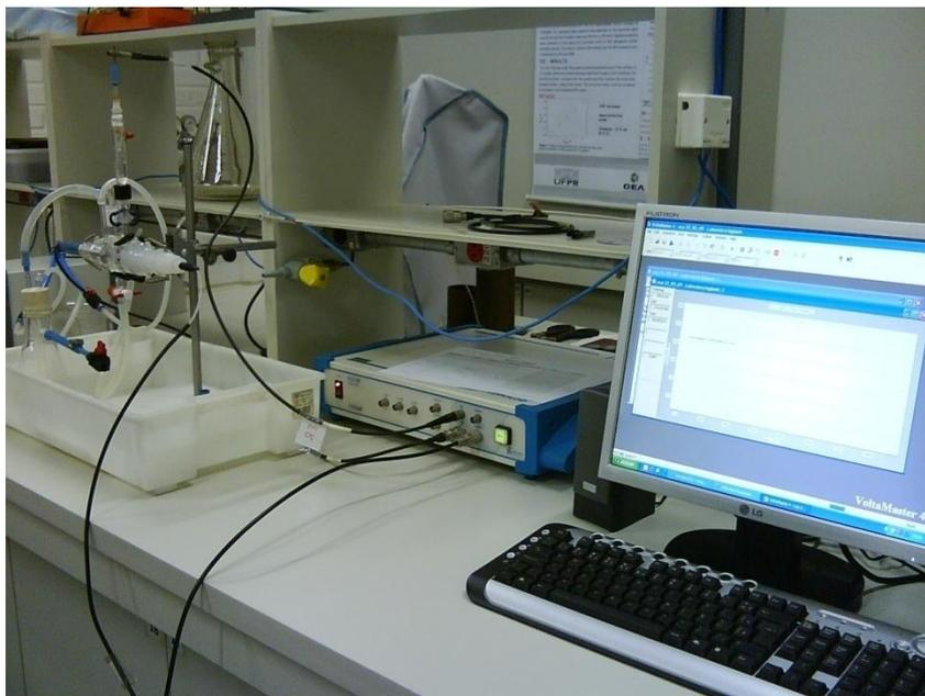
**Fotografia 5-** Aparato Experimental montado para a realização das medidas eletroquímicas.
