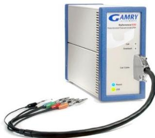
**Fotografia 7-** Potenciostato da Gamry Instruments utilizado na realização dos testes de ruído eletroquímico.
