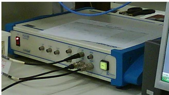
**Fotografia 4-** *VoltaLab PGZ100 utilizado nos testes.*
