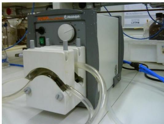
**Fotografia 3-** Bomba peristáltica utilizada nos testes
