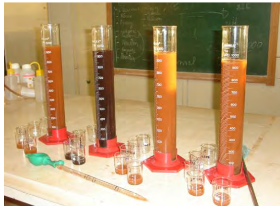
Figura 10 – Equipamento utilizado no método de pipetagem: A) misturador mecânico para preparação das amostras de sedimentos com pirofosfato de sódio e água destilada, B) provetas e béqueres para a realização da pipetagem.
