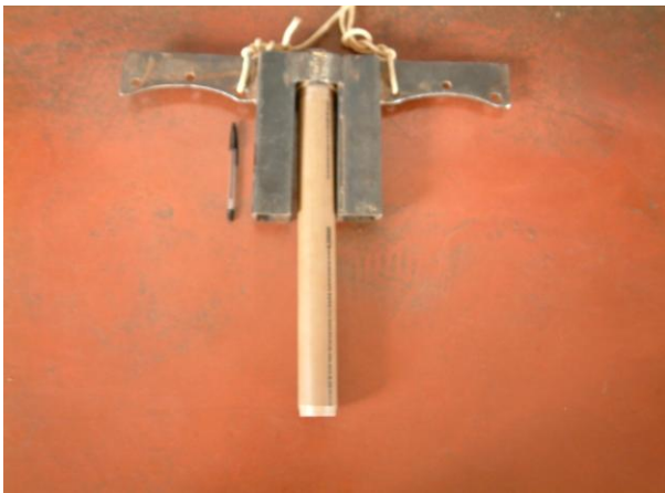
Figura 5: A) Amostrador, adaptado do modelo Piston Core preparado para obtenção de testemunhos verticais B) Amostrador modelo Peterson (draga).
