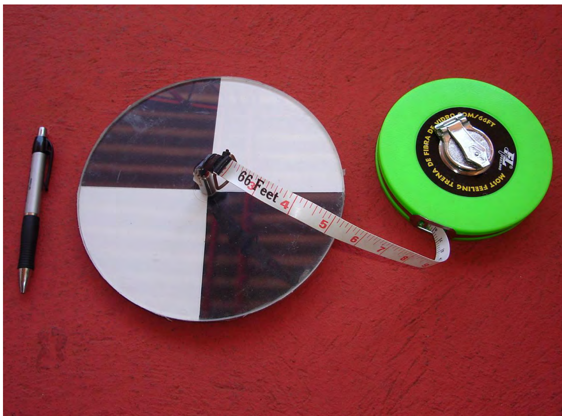
Figura 13 – Disco de Secchi – equipamento utilizado para avaliar a turbidez da água.
