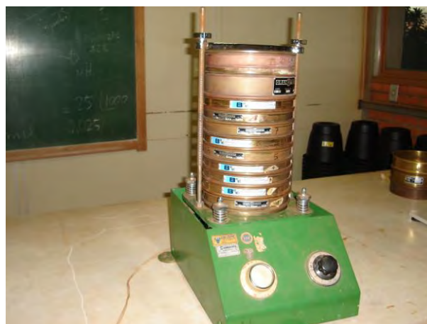
Figura 11 – Etapas do método de peneiramento: A) elutriação do material após a pipetagem B) agitador mecânico com jogo de peneiras utilizadas para separar as frações de areia.
