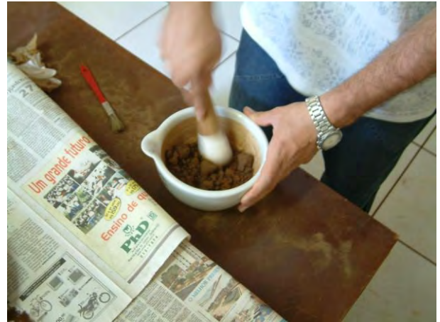
Figura 8: Processo de desagregação do material coletado em campo: A) após secagem em estufa, B) utilização de almofariz de porcelana e pistilo de madeira com ponta de borracha.
