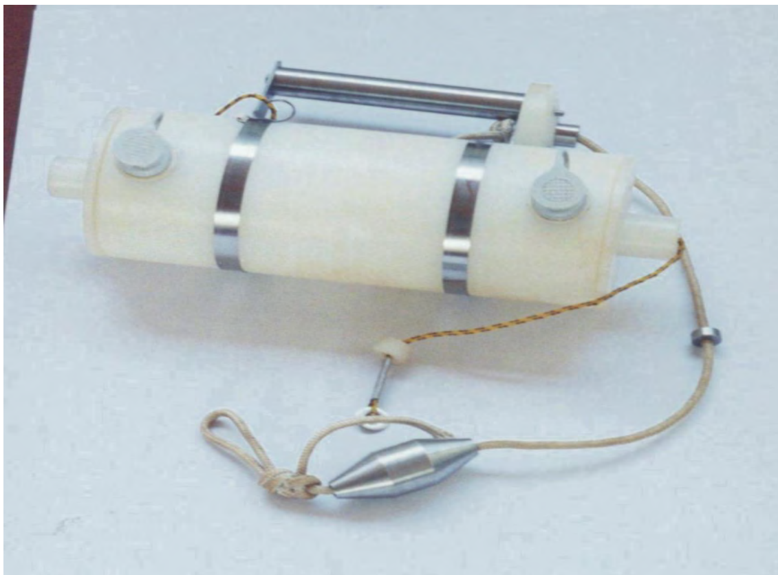
Figura 12 – Garrafa de Van Dorn - equipamento utilizado para coletar as amostras de água.
