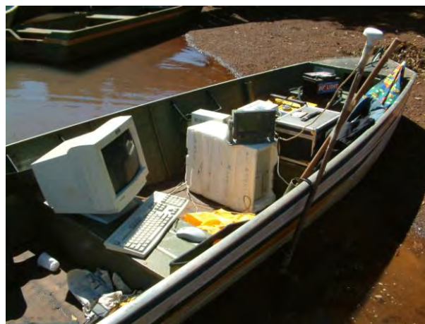
Figura 14: A) Ecosonda modelo Furuno GP-1650F, B) Sistema de Posicionamento Global (GPS), acoplados a um computador portátil utilizado na realização do levantamento batimétrico.
