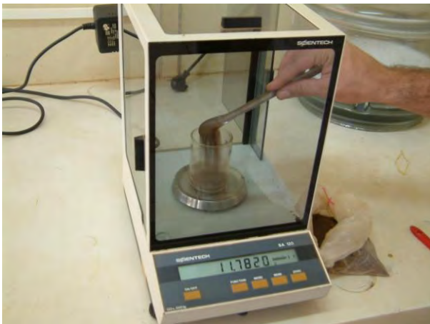
Figura 9 – A) Pesagem do material B) Processo de realização da queima de matéria orgânica com a utilização de peróxido de hidrogênio.
