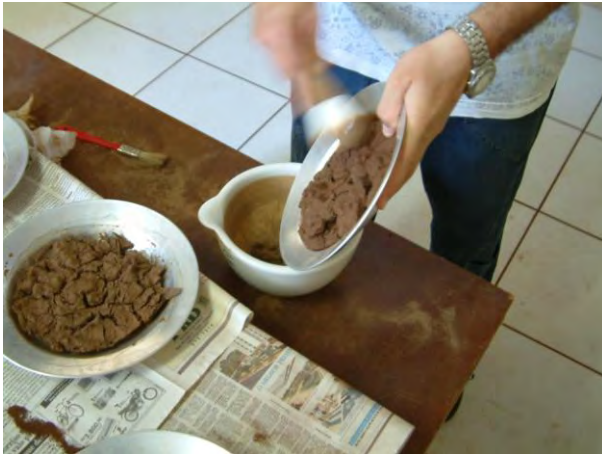
Figura 8: Processo de desagregação do material coletado em campo: A) após secagem em estufa, B) utilização de almofariz de porcelana e pistilo de madeira com ponta de borracha.
