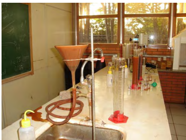
Figura 11 – Etapas do método de peneiramento: A) elutriação do material após a pipetagem B) agitador mecânico com jogo de peneiras utilizadas para separar as frações de areia.
