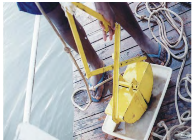
Figura 5: A) Amostrador, adaptado do modelo Piston Core preparado para obtenção de testemunhos verticais B) Amostrador modelo Peterson (draga).
