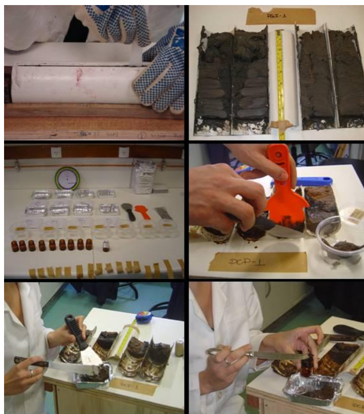
FIGURA 7 - ABERTURA DOS TESTEMUNHOS LOGO APÓS A ETAPA DE CAMPO NA ESTAÇÃO BRASILEIRA COMANDANTE FERRAZ (EACF).
