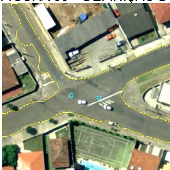
FIGURA 50 – DEFINIÇÃO DOS PONTOS SEMENTES DOS CRUZAMENTOS DE VIAS
