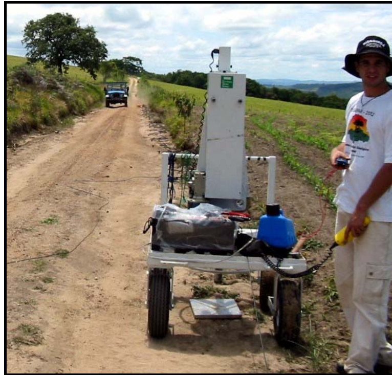
Foto 19: Fonte sísmica utilizada – queda de peso acelerada. O peso é liberado por um controle remoto e cai sobre uma placa metálica gerando a energia sísmica que se propaga no subsolo e retorna aos geofones gerando os sismogramas ou registros sísmicos.
