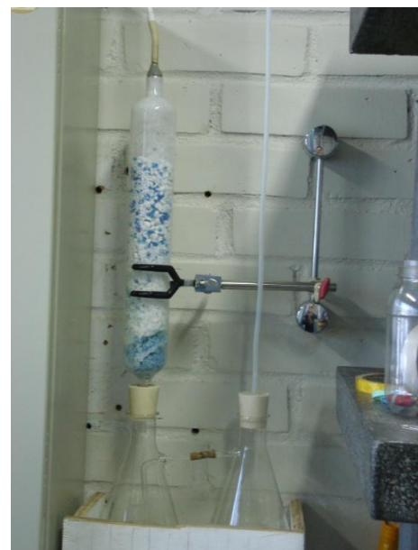
FIGURA 6 – ESQUEMA E FOTOGRAFIA DO SISTEMA DE SECAGEM DO AR PARA ANALISADOR DE GASES
