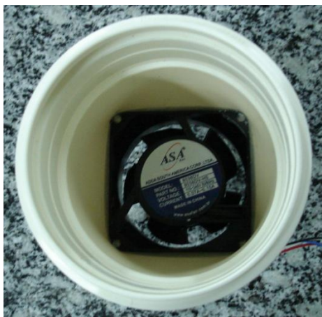
FIGURA 19 – FOTOGRAFIA DA PARTE INFERIOR DO INSTRUMENTO MONTADO PARA A SECAGEM EM CAMADA DELGADA.
