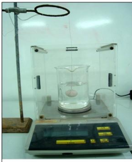
Figura 11 – Exemplo do método de Balança de Arquimedes.
