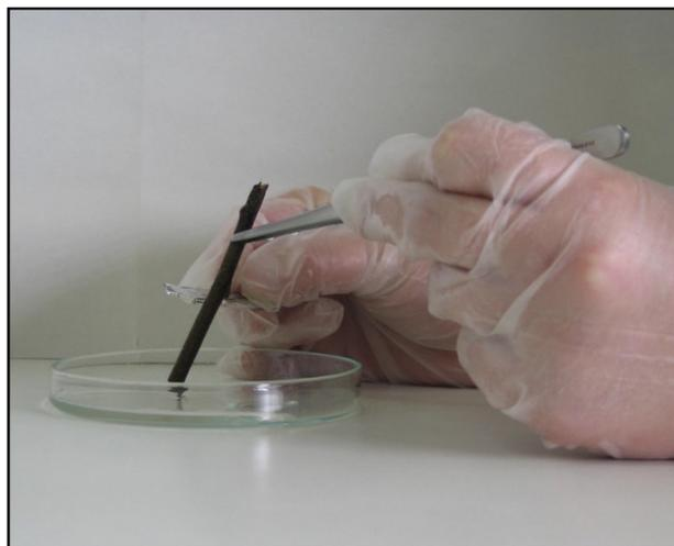
FIGURA 8 - REMOÇÃO DO MATERIAL PERIFÍTICO COM LÂMINA DE BARBEAR ENVOLTA EM PAPEL ALUMÍNIO.
