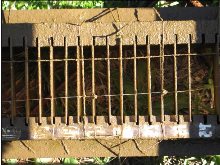
FIGURA 6 - ASPECTO DAS LÂMINAS DE VIDRO APÓS 30 DIAS DE SUBMERSÃO NO RESERVATÓRIO.
