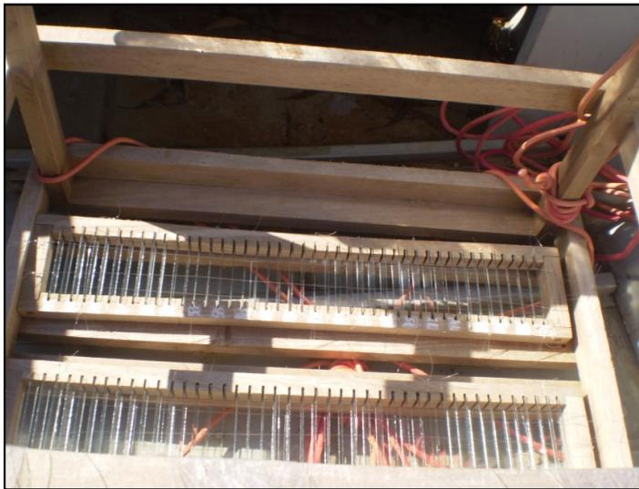
FIGURA 4 - SUPORTE COM LÂMINAS DE VIDRO UTILIZADO PARA A INSTALAÇÃO DO EXPERIMENTO COM SUBSTRATO ARTIFICIAL.
