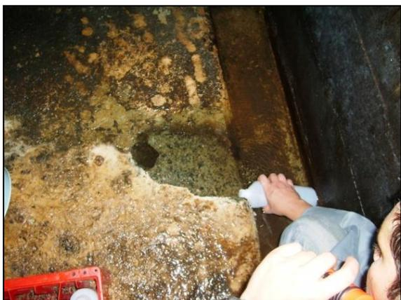
Figura 31 - Coleta de amostra de água no dreno de fundação (AP1)
