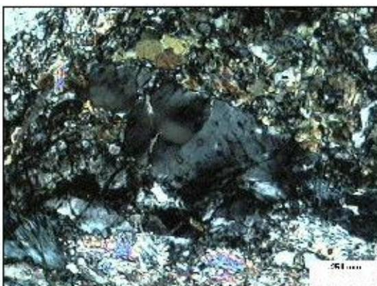
(b) Quartzo fraturado e com extinção ondulante (aumento 40X / luz natural)
