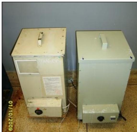
(b) tanques para cura alcalina utilizados para o ensaio acelerado
