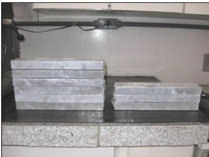
Figura 48 - Barras de argamassa após ensaio acelerado
