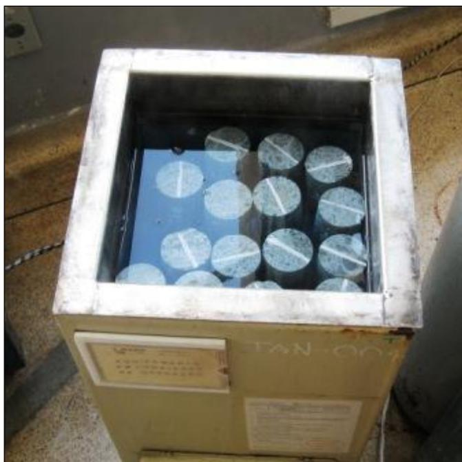
Figura 45 - Corpos de prova cilíndricos dentro de tanque com solução (NaOH, 1N a 80 °C)
