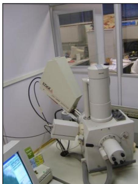
(b) microscópio eletrônico de varredura com microsonda analítica de raios X acoplada
