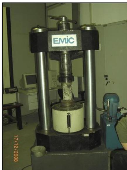
(b) execução do ensaio de resistência à compressão axial
