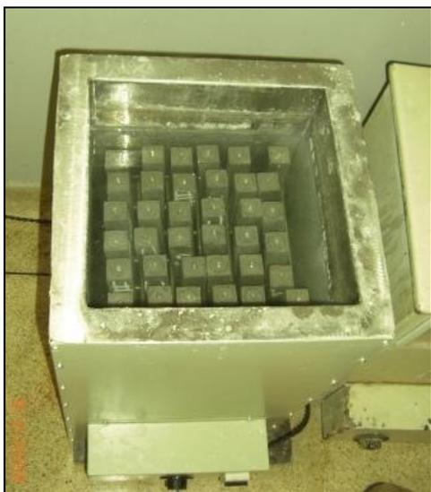
(a) disposição das barras de argamassa dentro do tanque com solução alcalina (NaOH, 1N a 80 °C)
