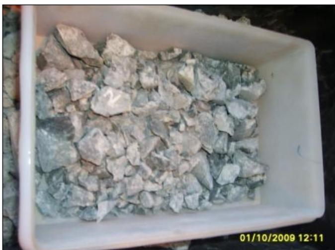
Figura 42 - Agregados separados do concreto da barragem
