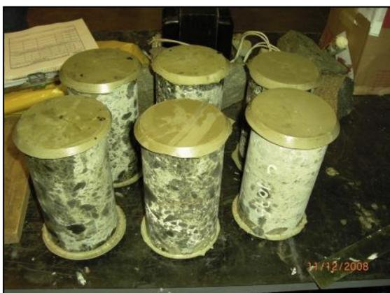
(a) corpos de prova capeados com enxofre
