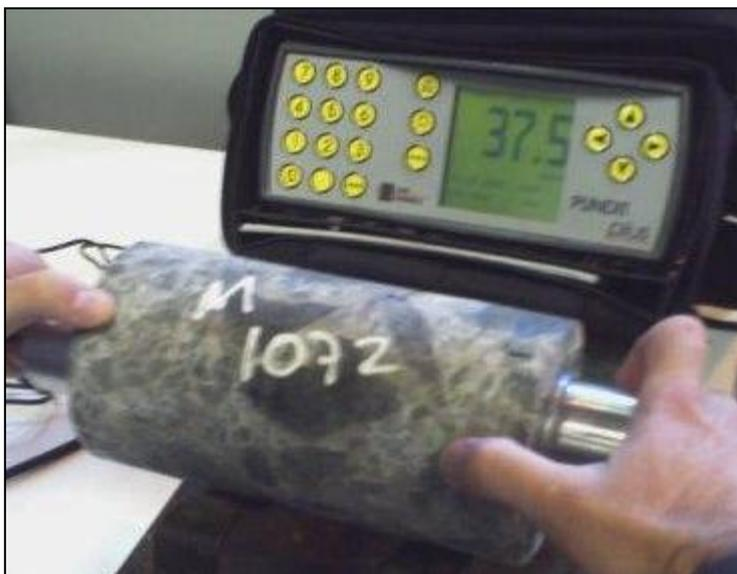
Figura 55 - Execução do ensaio de ultrassom no CP do local E3
