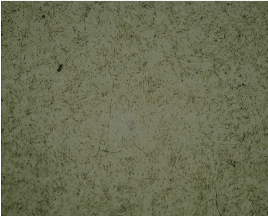
FIGURA 28 (C) - TEMPERATURA DE AUSTENITIZAÇÃO DE 1020 °C E REVENIMENTO A 550 °C (AMOSTRA COM TRÊS REVENIMENTOS).
