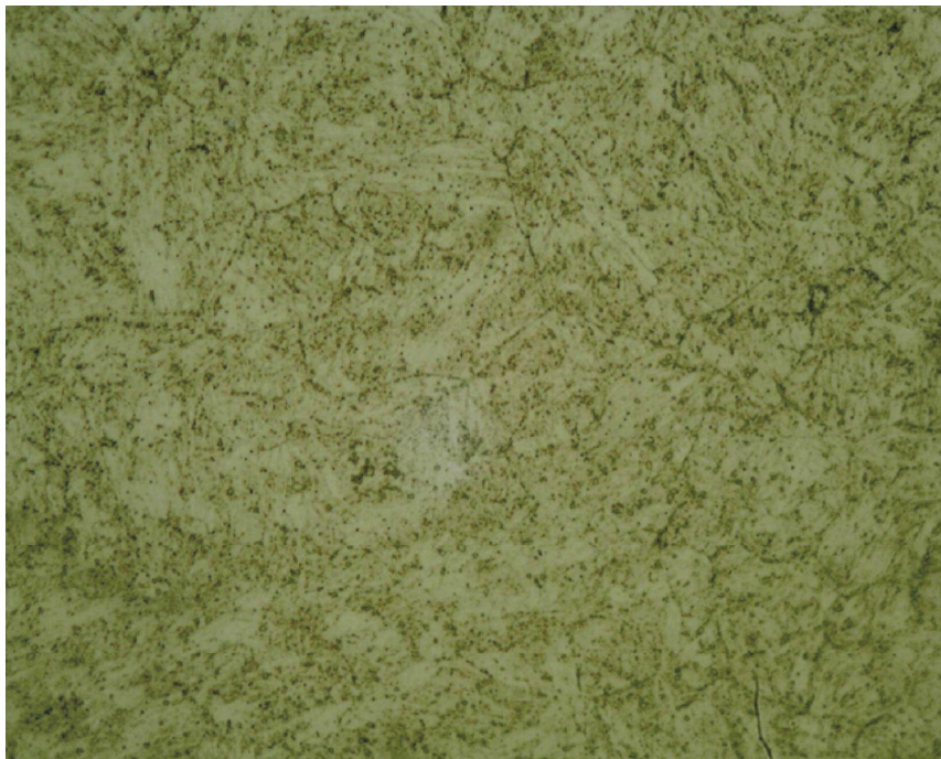
FIGURA 26 (A) – TEMPERATURA DE AUSTENITIZAÇÃO DE 1020 °C E REVENIMENTO A 630 °C (AMOSTRA COM UM REVENIMENTO).
