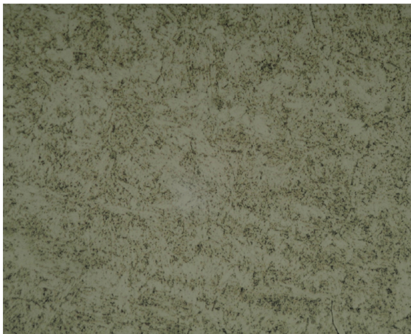
FIGURA 26 (B) - TEMPERATURA DE AUSTENITIZAÇÃO DE 1020 °C E REVENIMENTO A 630 °C (AMOSTRA COM DOIS REVENIMENTOS).
