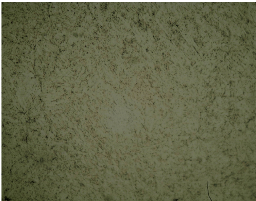
FIGURA 28 (B) - TEMPERATURA DE AUSTENITIZAÇÃO DE 1020 °C E REVENIMENTO A 550 °C (AMOSTRA COM DOIS REVENIMENTOS).
