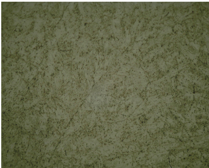
FIGURA 27 (C) - TEMPERATURA DE AUSTENITIZAÇÃO DE 1020 °C E REVENIMENTO A 600 °C (AMOSTRA COM TRÊS REVENIMENTOS).
