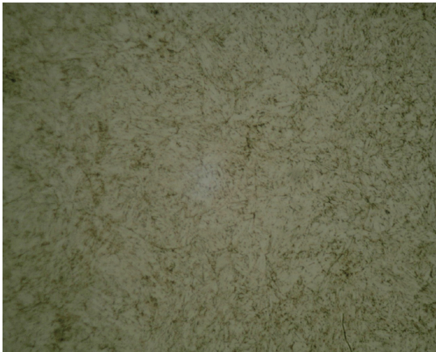
FIGURA 28 (A) - TEMPERATURA DE AUSTENITIZAÇÃO DE 1020 °C E REVENIMENTO A 550 °C (AMOSTRA COM UM REVENIMENTO).
