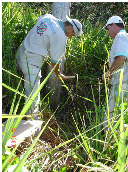
FIGURA 5 - INSPEÇÃO POR PERCUSSÃO FONTE: A autora (2007)
