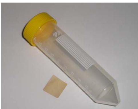
Figura 11 – Amostras (seção quadrada utilizadas durante os ensaios de degradação).
