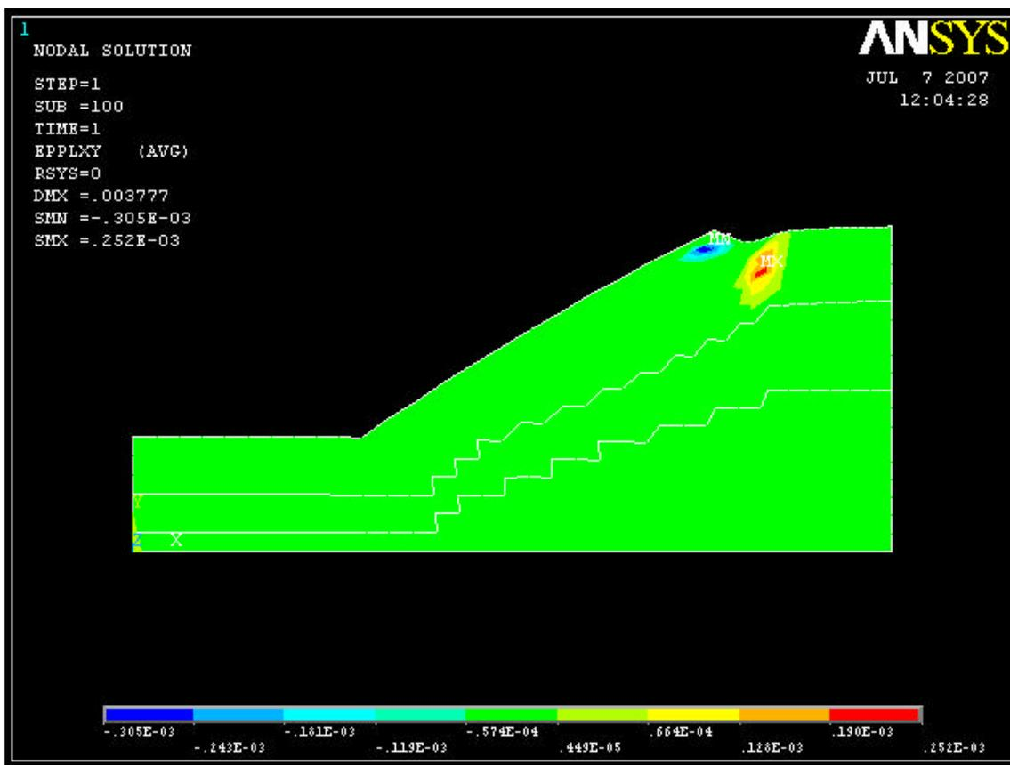
FIGURA 31 DISTRIBUIÇÃO DO COMPONENTE  $E_{ZZ}^p$  DAS DEFORMAÇÕES PLÁSTICAS GERADA PELO PROGRAMA DESENVOLVIDO.
