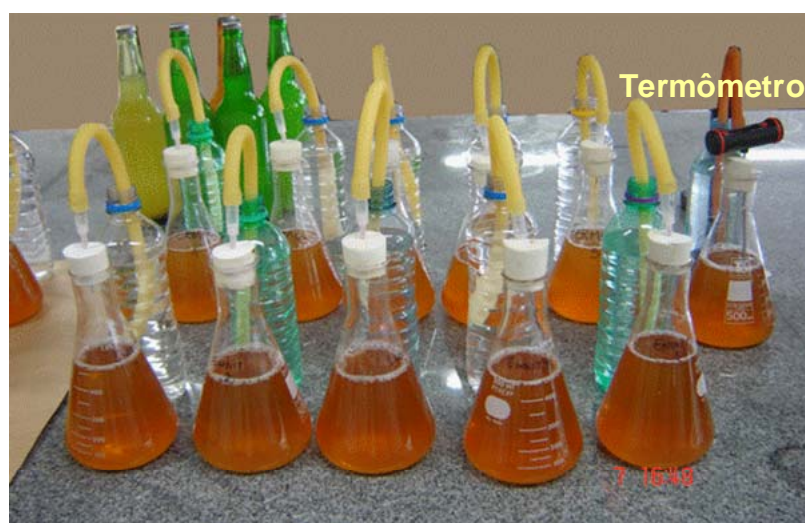
Figura 2.8 Fermentadores menores e monitoramento de temperatura na fermentação
