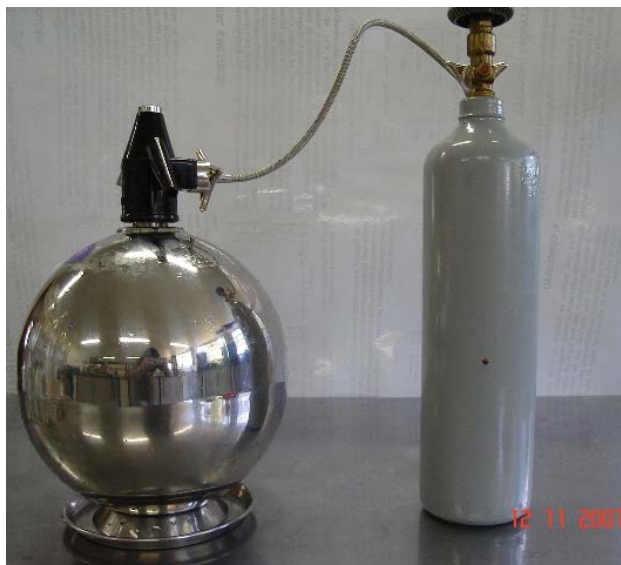
Figura 5.7 Gaseificador acoplado ao cilindro de gás carbônico
