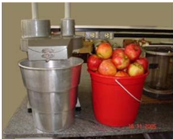
Figura 2.4 Processador de facas utilizado para triturar as frutas
