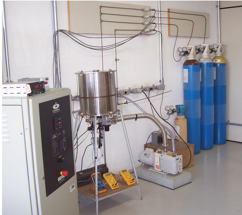
Figura 17: Instalação para nitretação por plasma do LTPP/UFPR.
