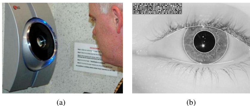
FIGURA 13: IDENTIFICAÇÃO POR RECONHECIMENTO DA ÍRIS: (a) CAPTURA DA IMAGEM E (b) ÍRIS COM SEU RESPECTIVO CÓDIGO.
