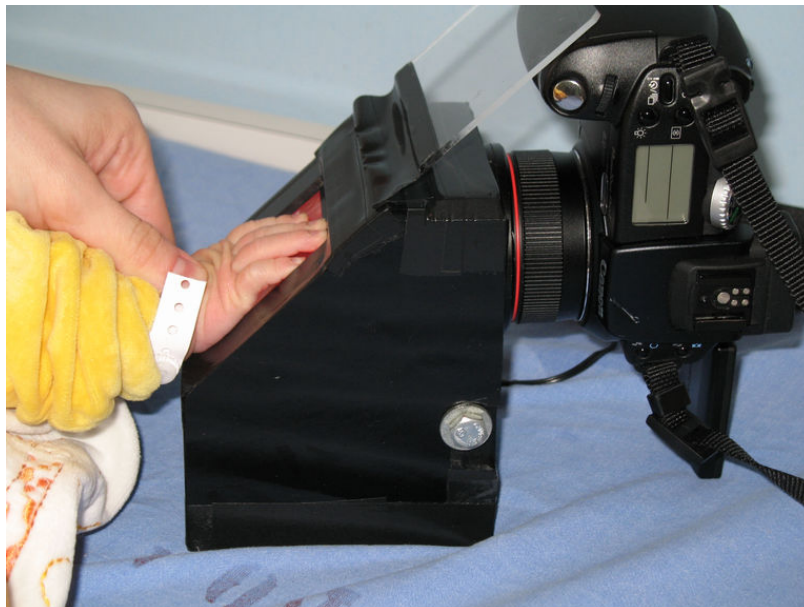
FIGURA 20: SENSOR ÓTICO IMAGORNID DESENVOLVIDO PARA CAPTURA IMPRESSÕES PLANTARES E PALMARES DE RECÉM-NASCIDOS.
