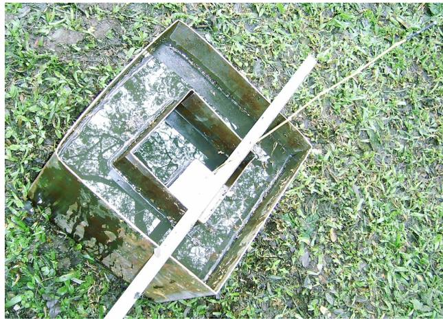
FIGURA 35 – Foto do infiltrômetro retangular com água e vareta marcadora de variação de lâmina
