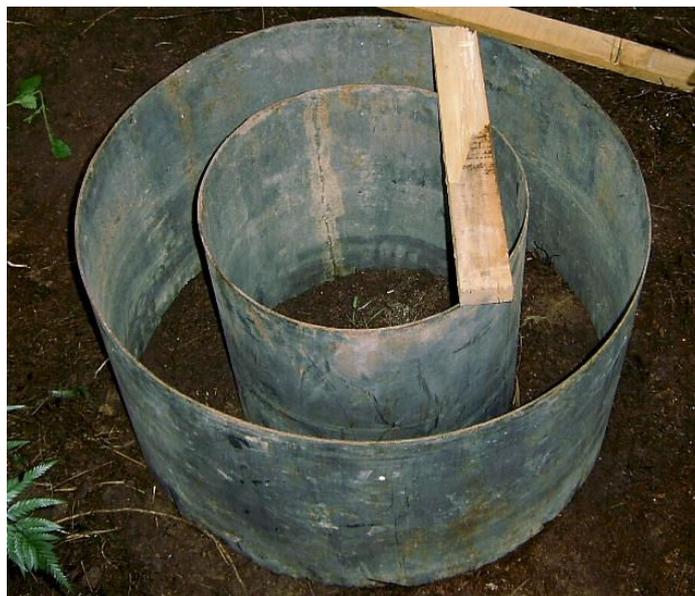
FIGURA 30 – Foto do Infiltrômetro de anéis concêntricos
