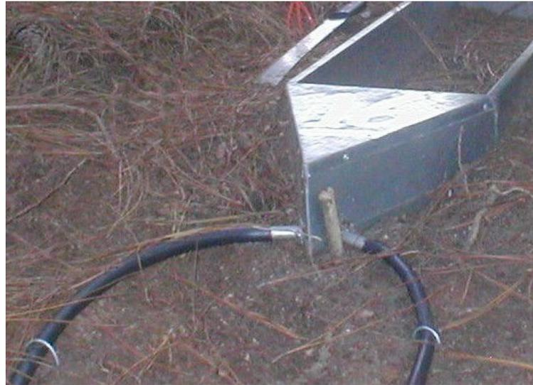
FIGURA 17 – Foto do encaixe dos tubos metálicos com as mangueiras flexíveis
