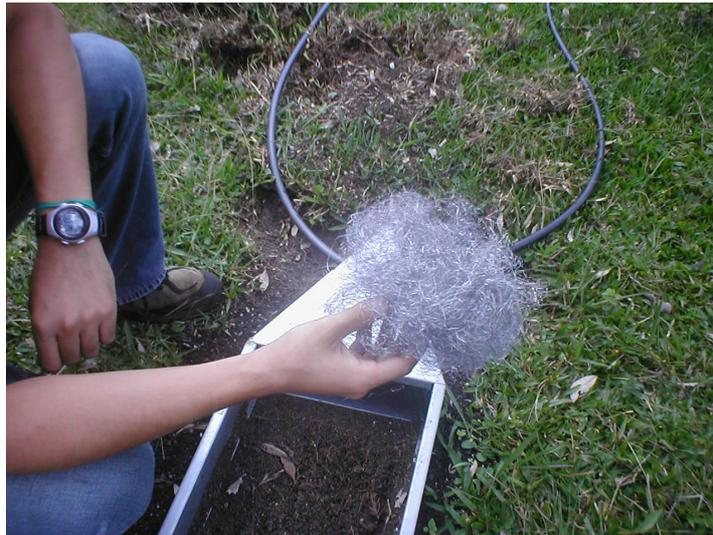
FIGURA 18 – Foto do elemento filtrante de palha de aço desfiada
