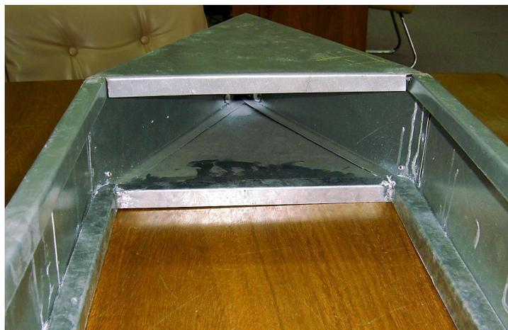
FIGURA 15 – Foto do acoplamento da estrutura triangular fechada com a estrutura retangular
