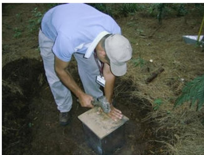
FIGURA 32 – Foto da colocação do infiltrômetro retangular
