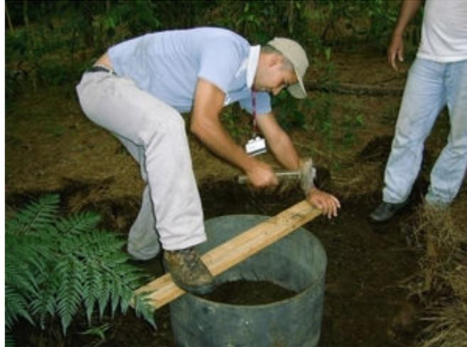
FIGURA 33 – Foto da colocação do infiltrômetro de anéis concêntricos
