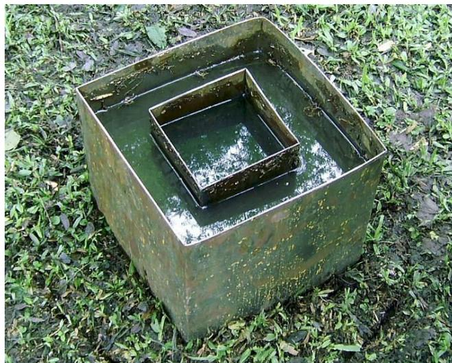
FIGURA 31 – Foto do infiltrômetro Retangular Duplo
