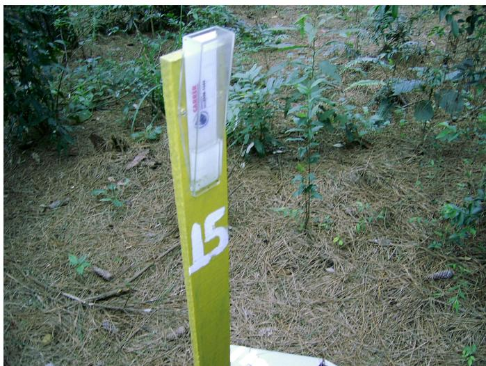
FIGURA 21 – Foto do pluviômetro com sua estaca fixadora
