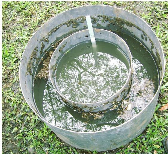
FIGURA 34– Foto do Infiltrômetro de anéis concêntricos com água e marca de nível
