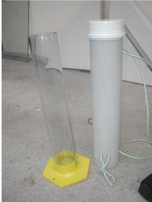
FIGURA 22 – Foto da Proveta de 2000 ml, base plástica e tubo de transporte
