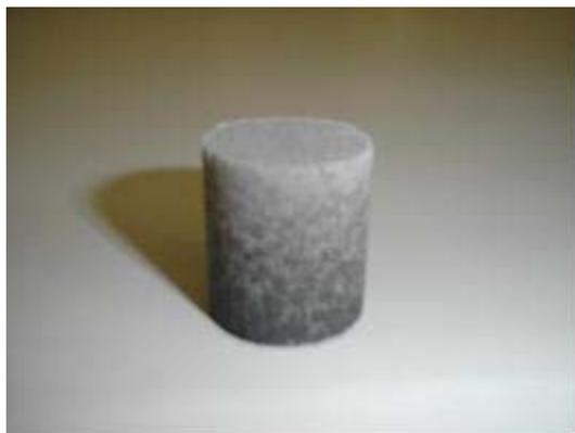
FIGURA 5 – Foto de um corpo de prova moldado com dimensão de 20 mm x 20 mm. As dimensões trabalhadas nos cp's foram definidas em função do tipo de moldagem e equipamentos disponíveis.
