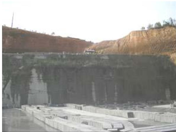
FIGURA 1 – Lavra de varvito em Trombudo Central. É visível a camada superficial de material argiloso retirada para atingir o nível do depósito da rocha. Algumas peças são recortadas nas dimensões de uso como pisos e tampas de mesas de bilhar. É consumido um volume significativo de água no corte das peças.
