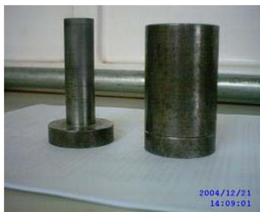
FIGURA 6 – Foto do molde utilizado na compactação dos corpos-de-prova. Fabricado em aço-carbono e constituído em três partes: cilindro, pistão e tampa.
