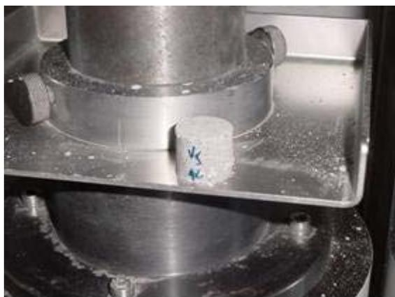
Figura 9 – Foto da ruptura do corpo de prova de composição V5 e idade de 90 dias. Após o ensaio de resistência mecânica à compressão os corpos de prova de composição V5 foram levados para o laboratório de raios-X para os ensaios de difração e fluorescência.
