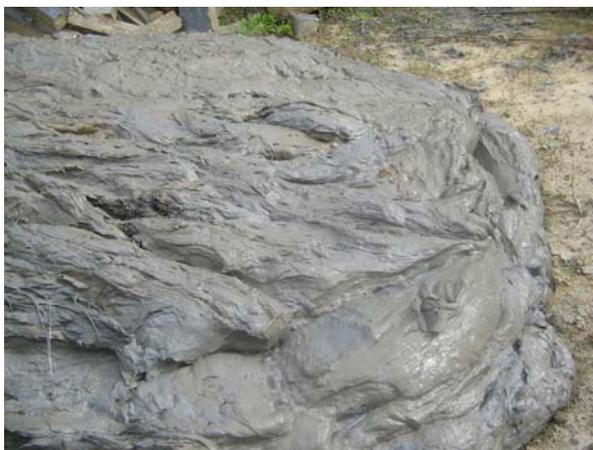
FIGURA 2 – Disposição Inadequada de Lama de Varvito. A lama de varvito que é gerada com o uso de água no corte da rocha é inicialmente depositada em caixas de sedimentação para a separação das fases líquido/sólido e evitar o contato com rios próximos à mineração. Quando as caixas estão saturadas, a lama é retirada e depositada em áreas de vegetação .
