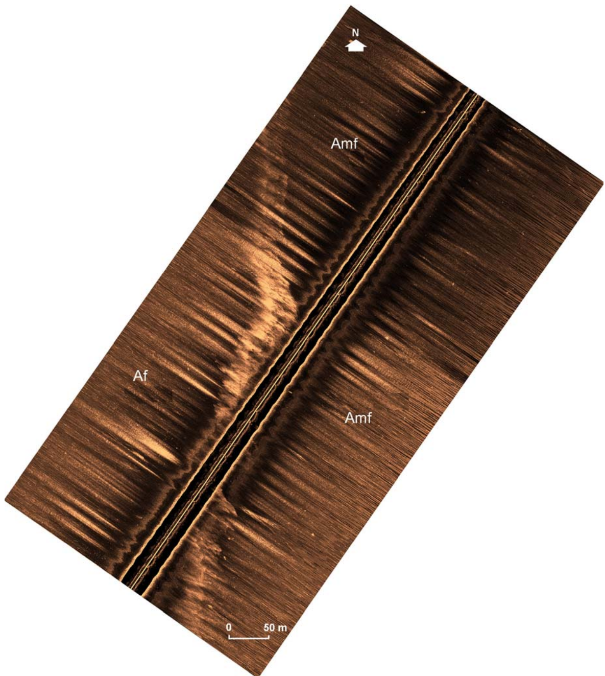
Figura 39: Imagem de sonar de varredura lateral do lobo terminal do delta de maré vazante localizado na desembocadura sul do CEP, onde pode ser observada a mudança nas características dos sedimentos de fundo de areia fina (Af) para areia muito fina (Amf).
