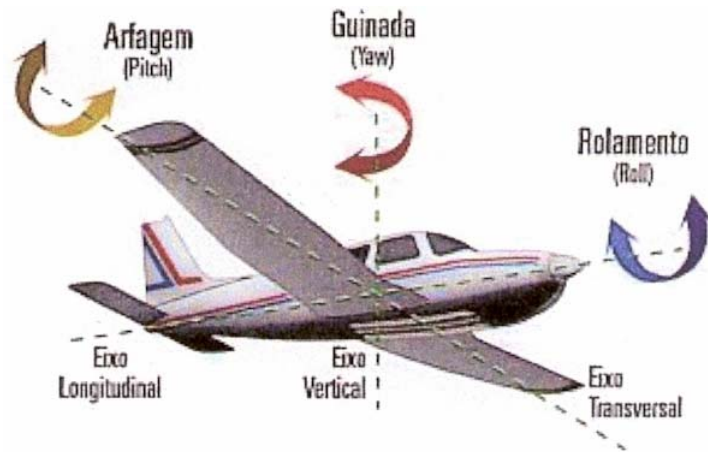
FIGURA 2: ÂNGULOS DE ATITUDE DA AERONAVE.
