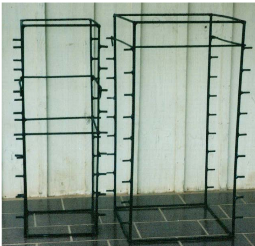
FIGURA 5 – ESTRATIFICADORES – EQUIPAMENTOS UTILIZADOS PARA EFETUAR CORTES SEGMENTADOS DAS FORRAGENS, AO LONGO DO PERFIL VERTICAL DO DOSSEL, A CADA 10 CM. CAMPO LARGO – PR, 2004.
