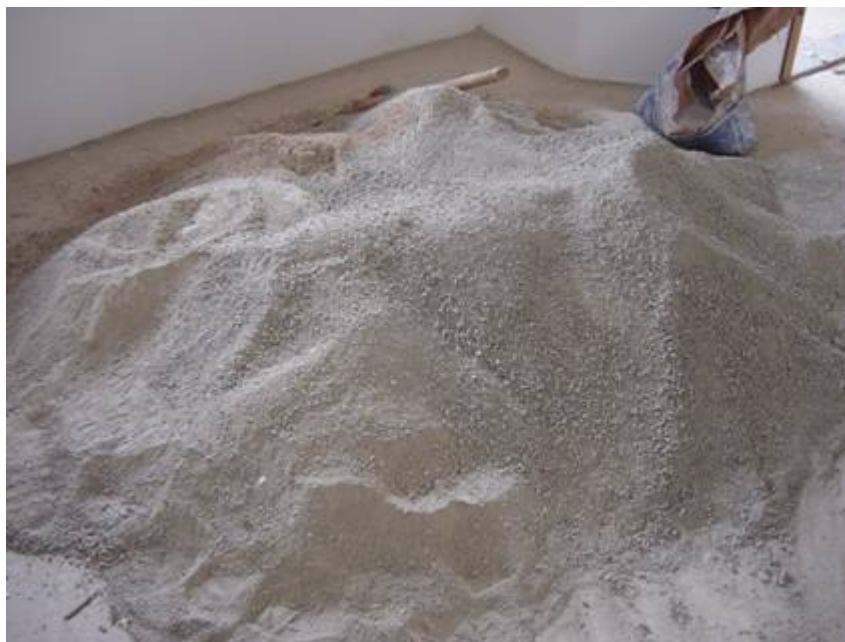
FIGURA 4.9 – RESÍDUO DA ARGAMASSA
