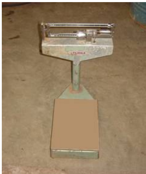
FIGURA 3.7 – BALANÇA UTILIZADA PARA A QUANTIFICAÇÃO DOS RESÍDUOS NA OBRA 1
