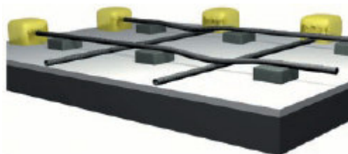
Fig. 06: Montagem de uma matriz de memória utilizando os nanotubos de carbono sobrepostos [50].
