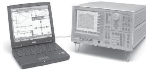
Fig. 18: Foto do Analisador de Parâmetros Semicondutores, 4155C, da Agilent Technologies usado para medidas IxV dos dispositivos .
