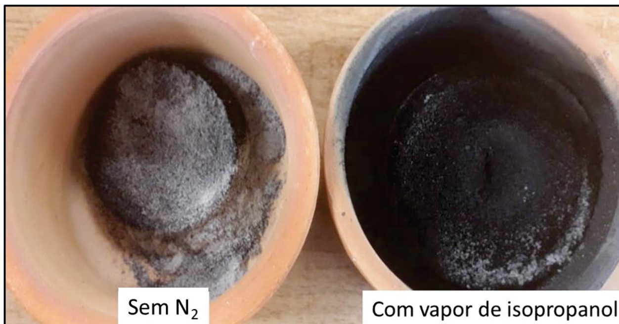
FIGURA 67 - TESTE COMPARATIVO ANTES DO INÍCIO DO TRABALHO ENTRE A PIRÓLISE CONVENCIONAL (SEM N 2 ) E PIRÓLISE COM VAPOR DE ISOPROPANOL PARA O BAGAÇO DE CANA-DE-AÇÚCAR.
