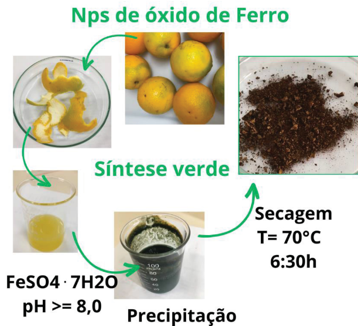
FIGURA 3.1 - ESQUEMA ILUSTRATIVO DO PROCESSO DE OBTENÇÃO DAS NANOPARTÍCULAS
