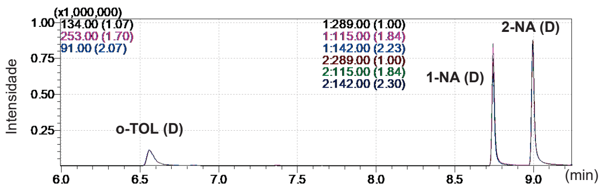
FIGURA 35 – CROMATOGRAMA OBTIDO EMPREGANDO AS CONDIÇÕES DE COMPROMISSO DE DERIVATIZAÇÃO COM PFPA – MODO SIM, 10,0 (o-TOL) E 1,0 mg L -1 (1-NA e 2-NA)
