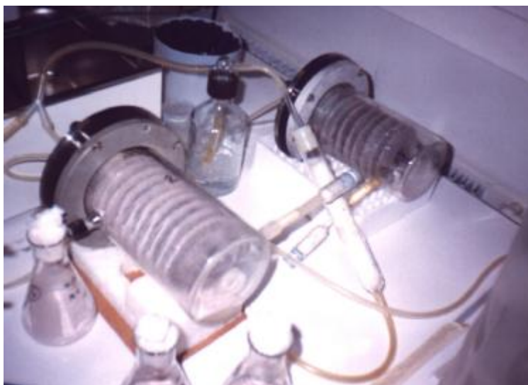
FIGURA 3.1. Dois fermentadores de discos utilizados para a produção de esporos de P. lilacinus Pl-1.
