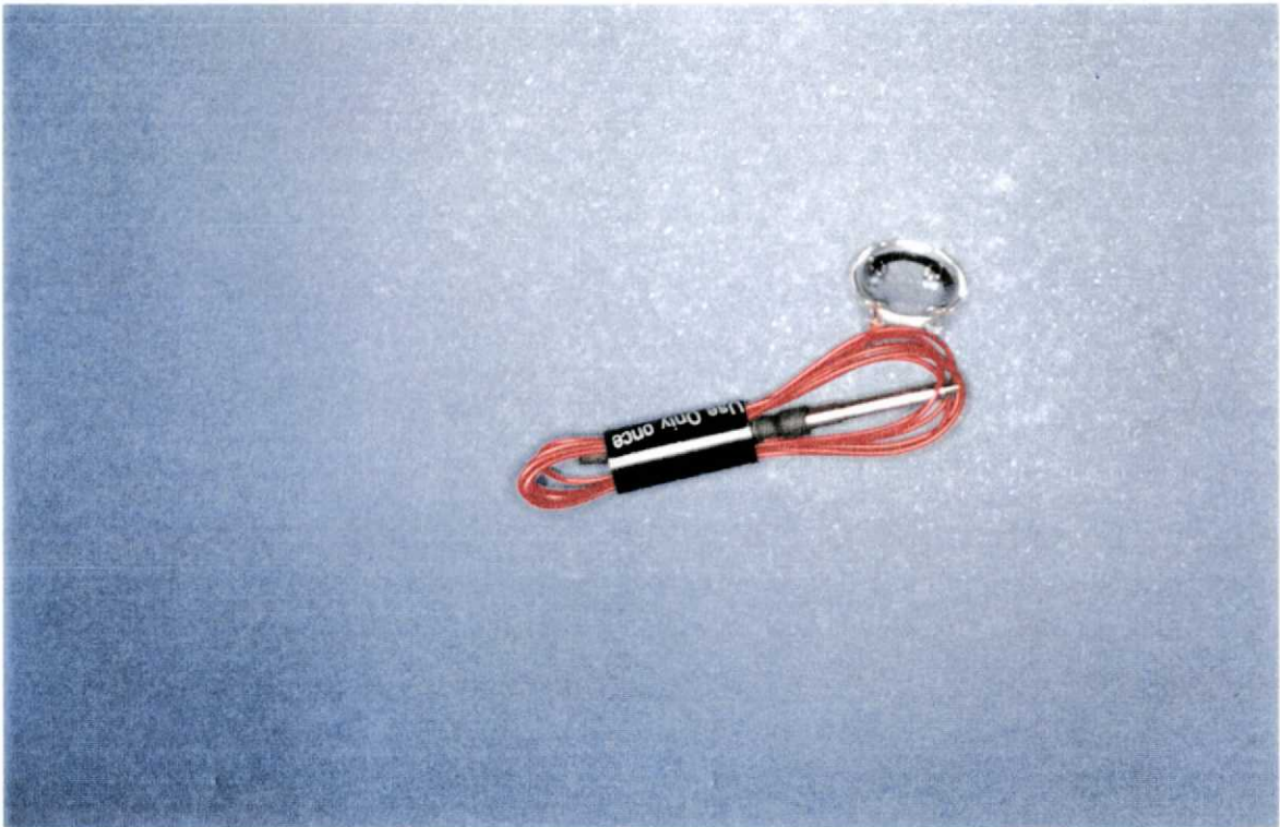
ERG Jet-electrodes (lente de contato) que se conecta na posição R+ e L+ no cabo do paciente.
