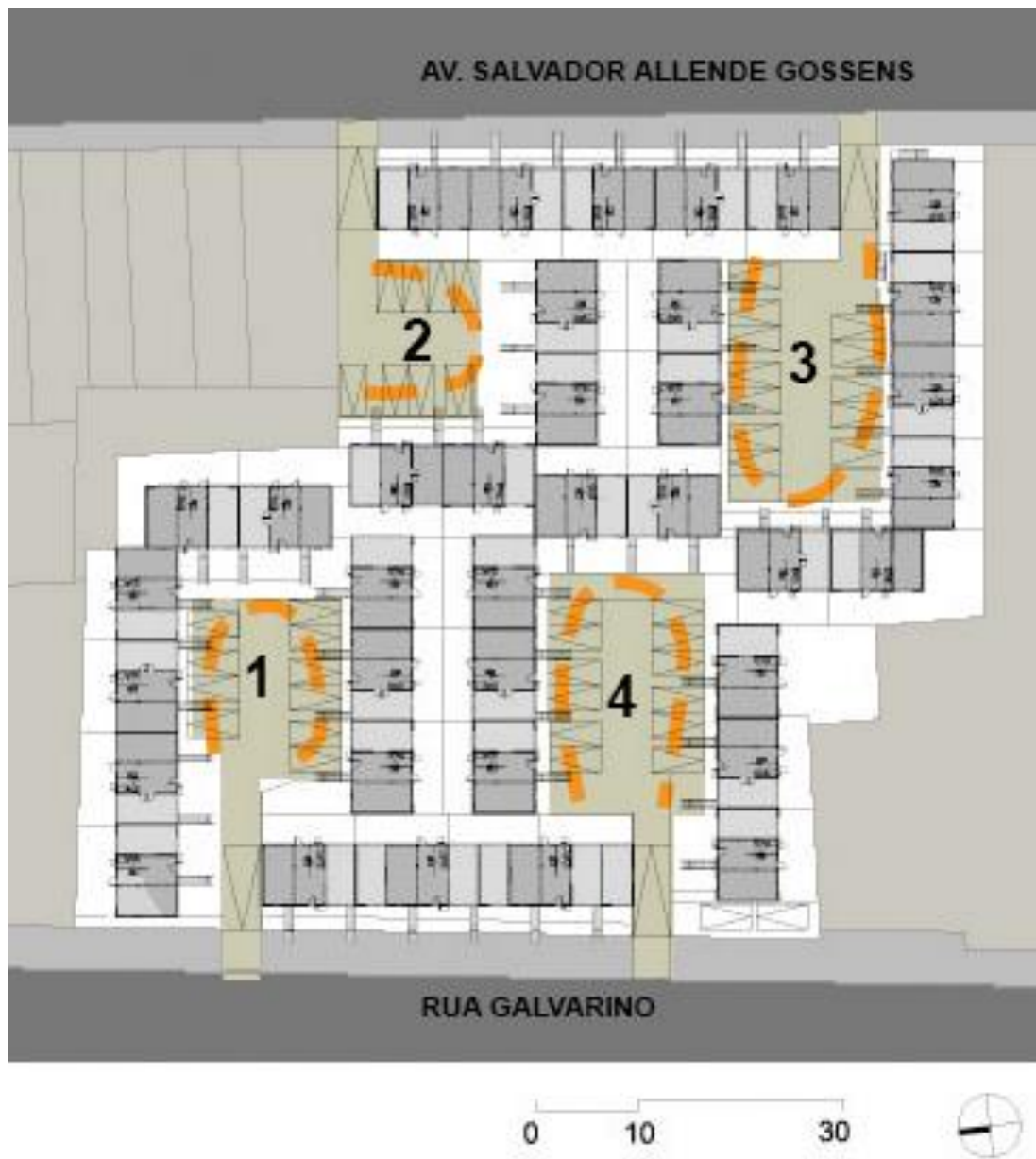
Figura 34: Implantação das Unidades. Destaque para as praças entres as habitações. (FONTE: ELEMENTAL). Editado pela Autora
