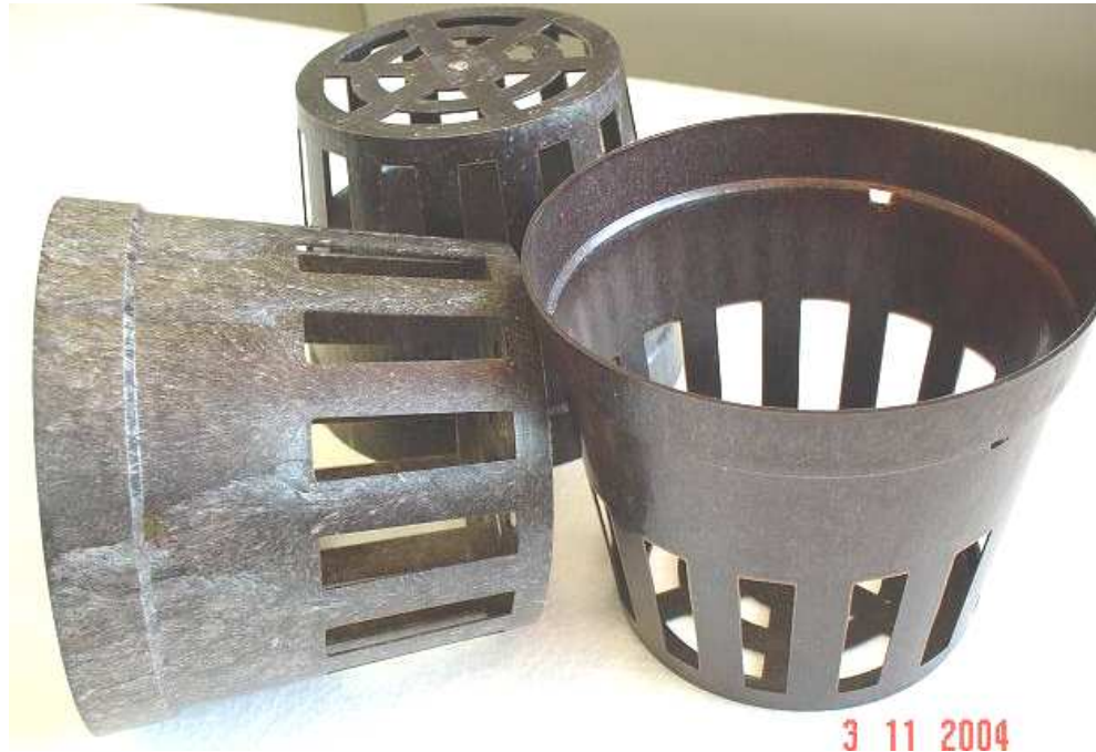
FIGURA 51 – VASOS PARA ORQUÍDEAS, INJETADO COM OS COMPÓSITOS PLÁSTICO-MADEIRA PRODUZIDOS E RECICLADOS
