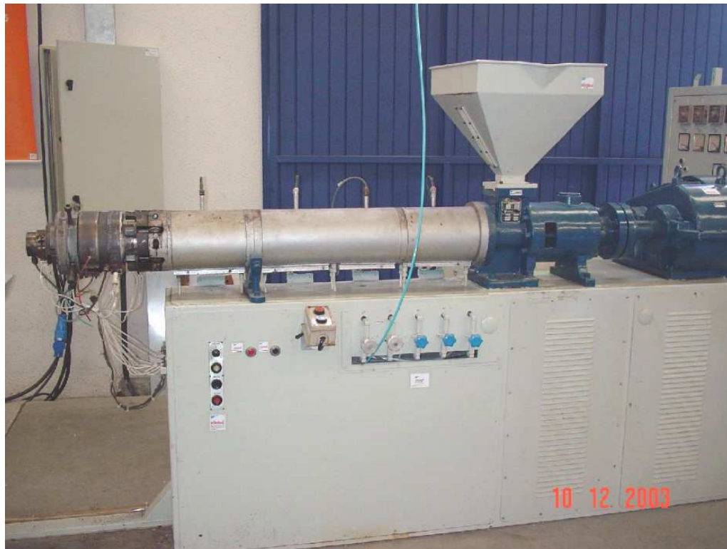
FIGURA 9 - EXTRUSORA MONORROCA UTILIZADA NA PRODUÇÃO DOS COMPÓSITOS PLÁSTICO-MADEIRA
