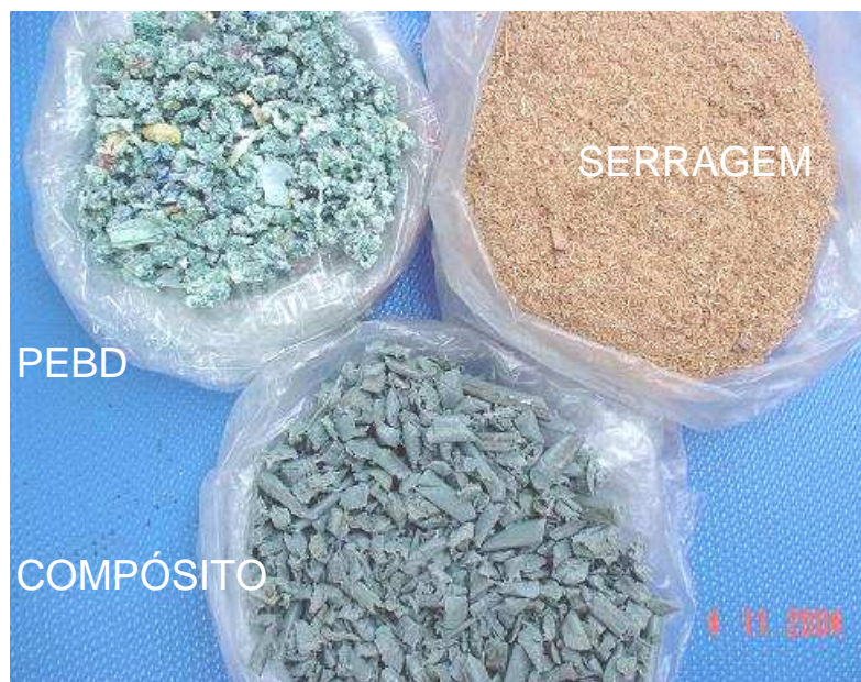
FIGURA 22 – COMPÓSITO PLÁSTICO-MADEIRA PRODUZIDOS A PARTIR DO PEBD RECICLADO
