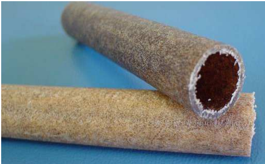
FIGURA 50 – TUBOS PRODUZIDOS COM COMPÓSITO PLÁSTICO-MADEIRA
