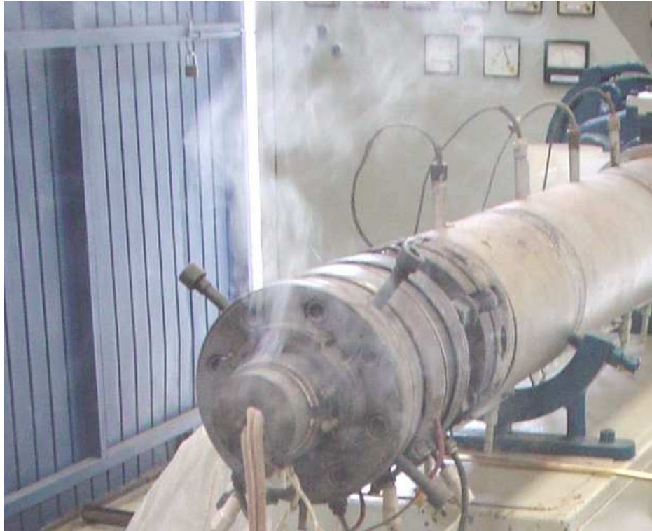
FIGURA 25 - LIBERAÇÃO DE GASES NA EXTRUSÃO REATIVA
