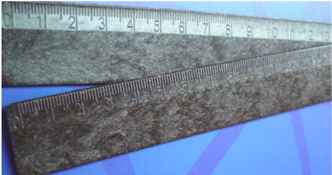
FIGURA 52 – RÉGUAS ESCOLARES, INJETADOS COM OS COMPÓSITOS PLÁSTICO-MADEIRA PRODUZIDOS
