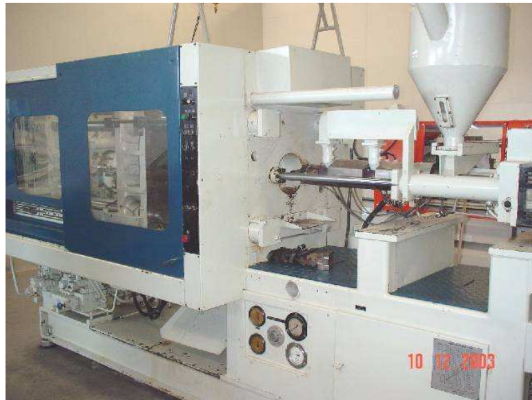
FIGURA 11 – INJETORA HORIZONTAL UTILIZADA NA PRODUÇÃO DOS CORPOS DE PROVA
