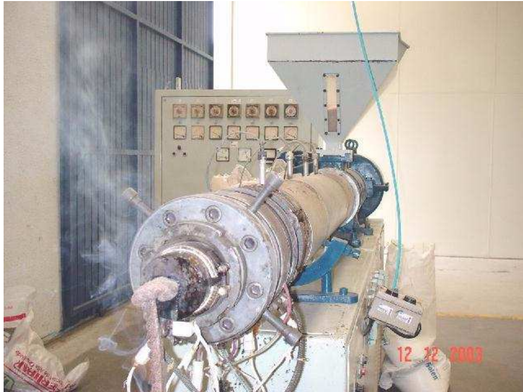
FIGURA 49 – EXTRUDADO IRREGULAR DEVIDO AOS GASES GERADOS NO INTERIOR DA EXTRUSORA
