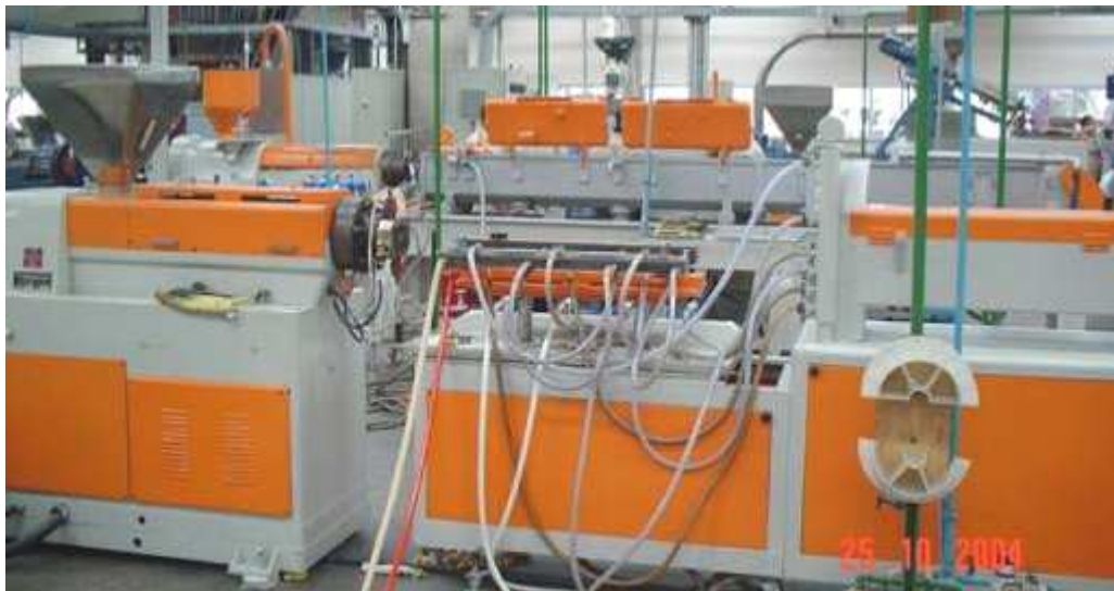
FIGURA 17 – EXTRUSORA MONORROSCA COM CALIBRADOR À VÁCUO E SISTEMA DE REFRIGERAÇÃO COM ÁGUA GELADA UTILIZADA NA PRODUÇÃO DE PERFIS
