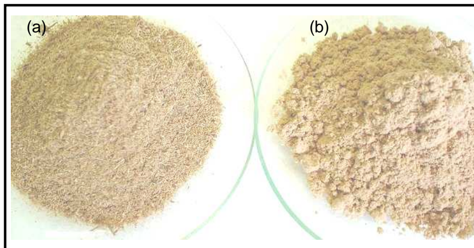
FIGURA 23 – SERRAGEM E PÓ-DE-LIXA UTILIZADOS NAS FORMULAÇÕES DOS COMPÓSITOS PLÁSTICO-MADEIRA PRODUZIDOS
