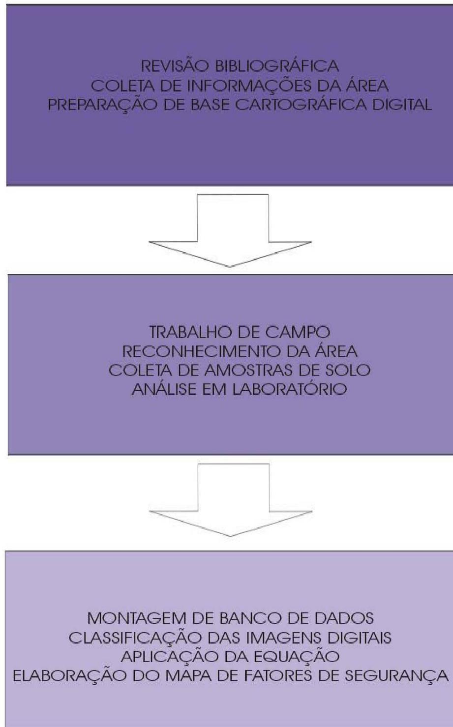
FLUXOGRAMA 01: FLUXOGRAMA PARA APLICAÇÃO DO MÉTODO.
