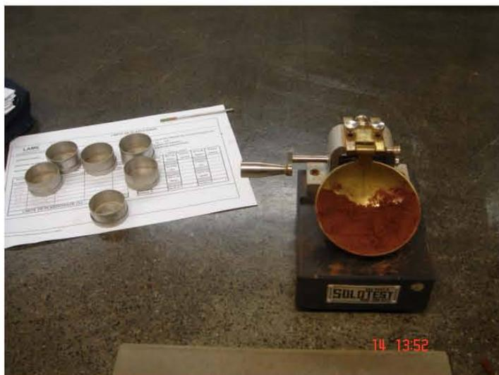
FIGURA 37 – DETALHE MOSTRANDO O APARELHO UTILIZADO PARA A DETERMINAÇÃO DO LIMITE DE LIQUIDEZ EM LABORATÓRIO.
