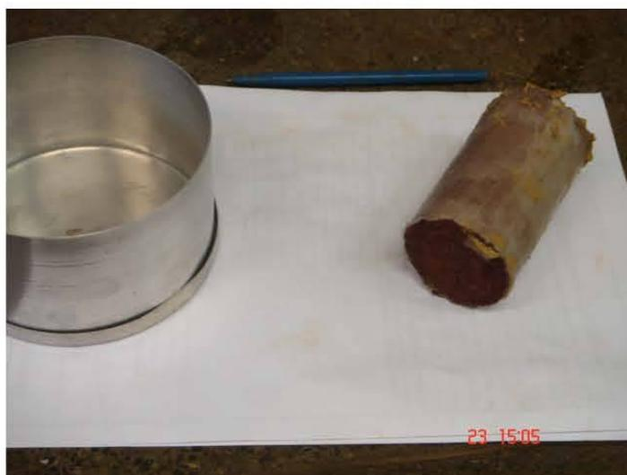
FIGURA 35 – DETALHES DA AMOSTRA COLETADA PARA O ENSAIO DE PERMEABILIDADE
