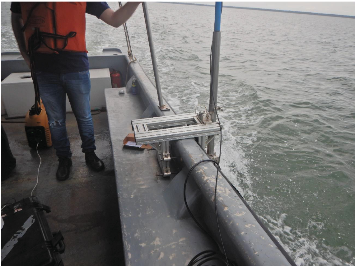
FIGURA 37 – SUPORTE DE FIXAÇÃO DO EQUIPAMENTO M9 A EMBARCAÇÃO
