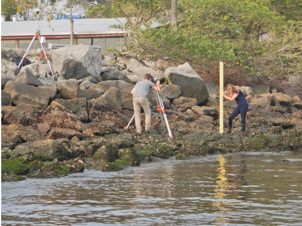
FIGURA 25 – RÉGUA LINIMÉTRICA UTILIZADA PARA MEDIR AS VARIAÇÕES DE MARÉ NO MOLHE
